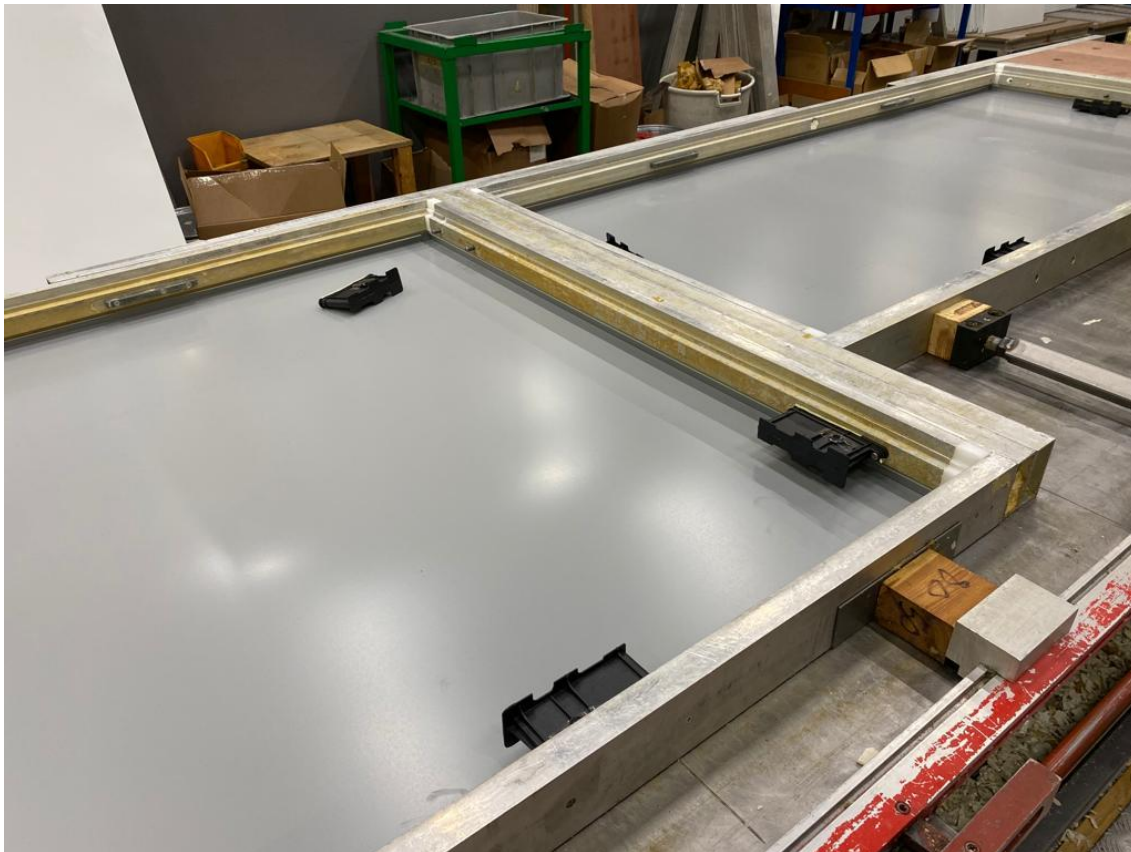
Kuva 1, Pohjapellin asettaminen muottiin ja lukkojen kiinnitys.
