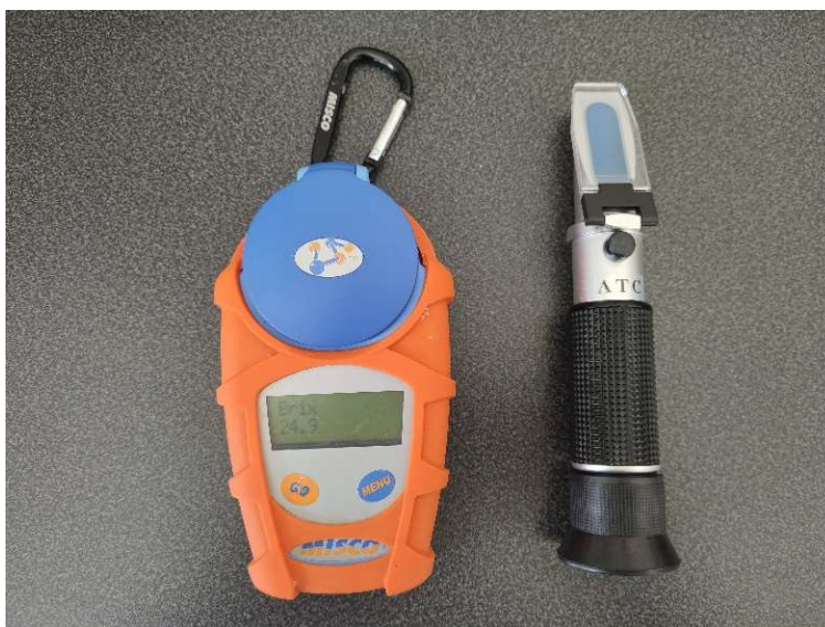
KUVA 5. Digitaalinen ja optinen refraktometri (Parkkinen 2020-12-01b)
