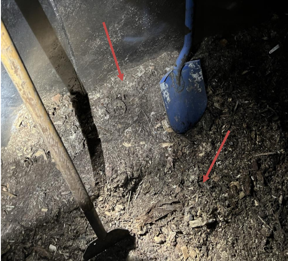
KUVA 26. Jäätynyt polttoaine siilon reunalla
