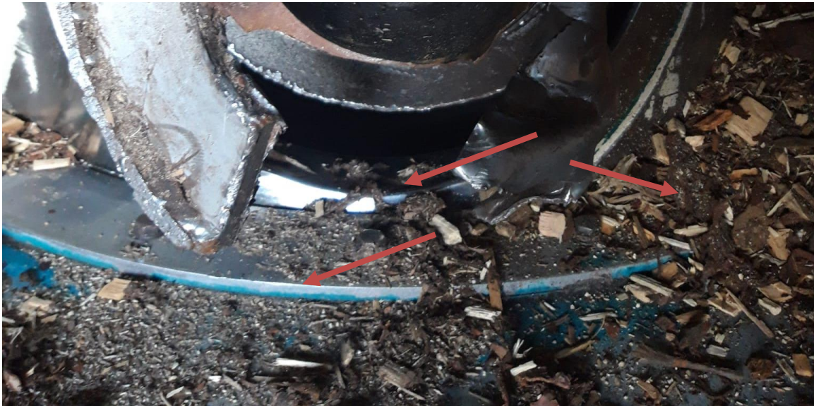
KUVA 22. Kynnykset ja suuret polttoaineen palaset syöttöaukon suulla (6, muokattu)
