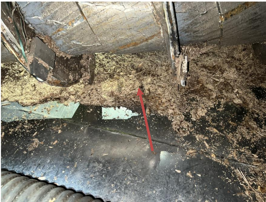
KUVA 25. Ruuvi, siilon pohja ja jäätynyt patja ruuvin alla
