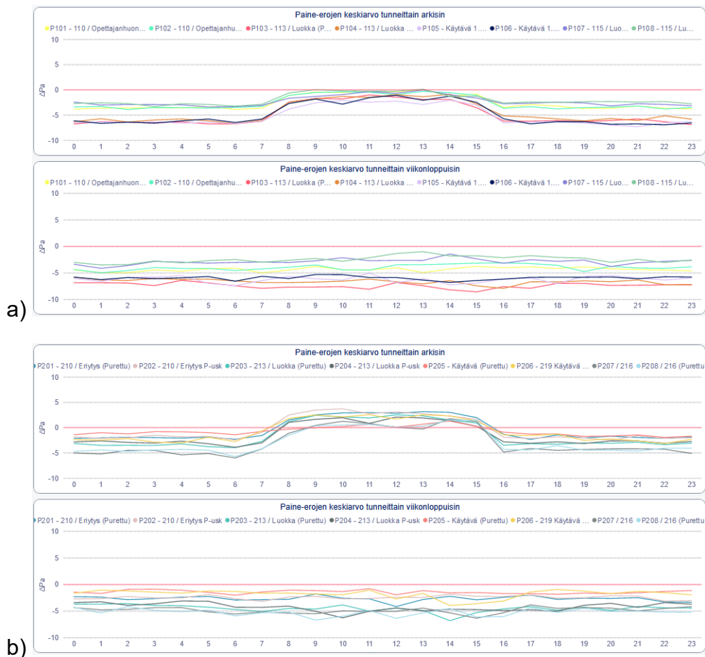
Kuva 8. a) Paine-erojen keskiarvo tunneittain arkisin ja viikonloppuisin, 1. kerros, b) Paine-erojen keskiarvo tunneittain arkisin ja viikonloppuisin, 2. kerros.
