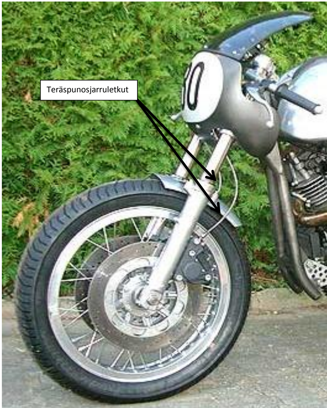
Kuva 26. Teräspunosjarruletkut vaihdettu TR1 moottoripyörään [28]
