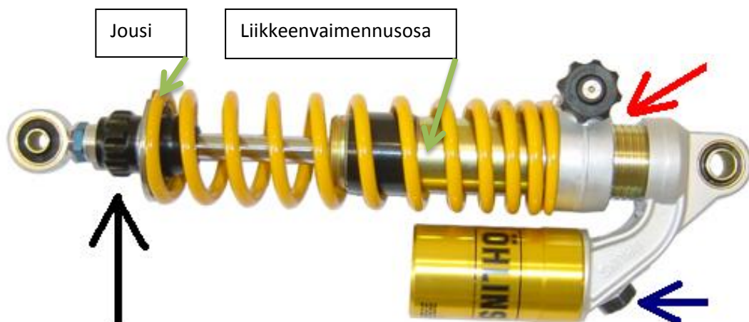
Kuva 7. Öhlins täysin säädettävä iskunvaimennin [10]
