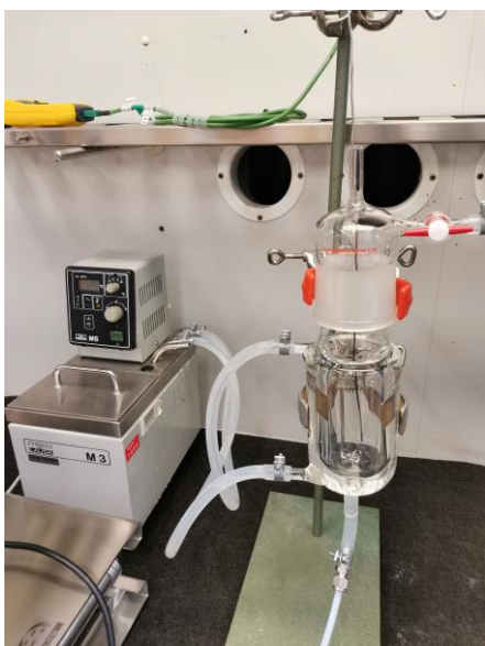
Kuva 14. Lasinen reaktioastia ja Lauda-lämpöhaude.
