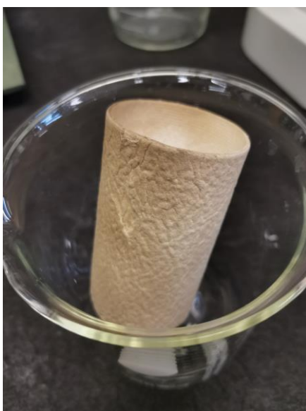
Kuva 21. Yön yli lämpökaapissa kuivattu Soxhlet-sukka, jonka sisällä on zeoliittikatalyytti ja lasivillaa.
