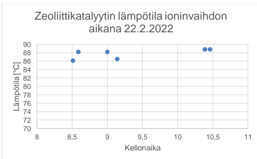
Kuva 2. Zeoliittikatalyytin lämpötila 22.2.2022 suoritetun ioninvaihdon aikana.
