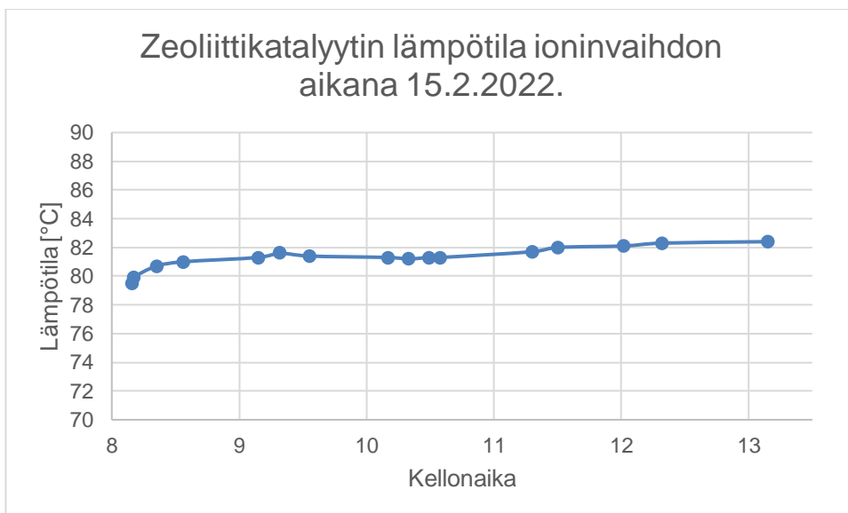
Kuva 19. Zeoliittikatalyytistä mitatut lämpötilat ioninvaihdon aikana.
