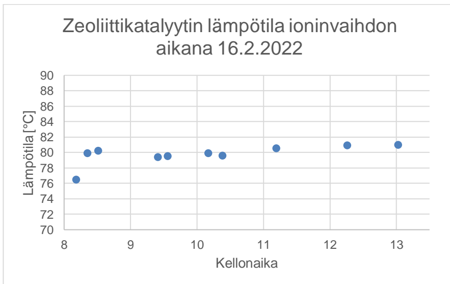
Kuva 1. Zeoliittikatalyytin lämpötila 16.2.2022 suoritetun ioninvaihdon aikana.
