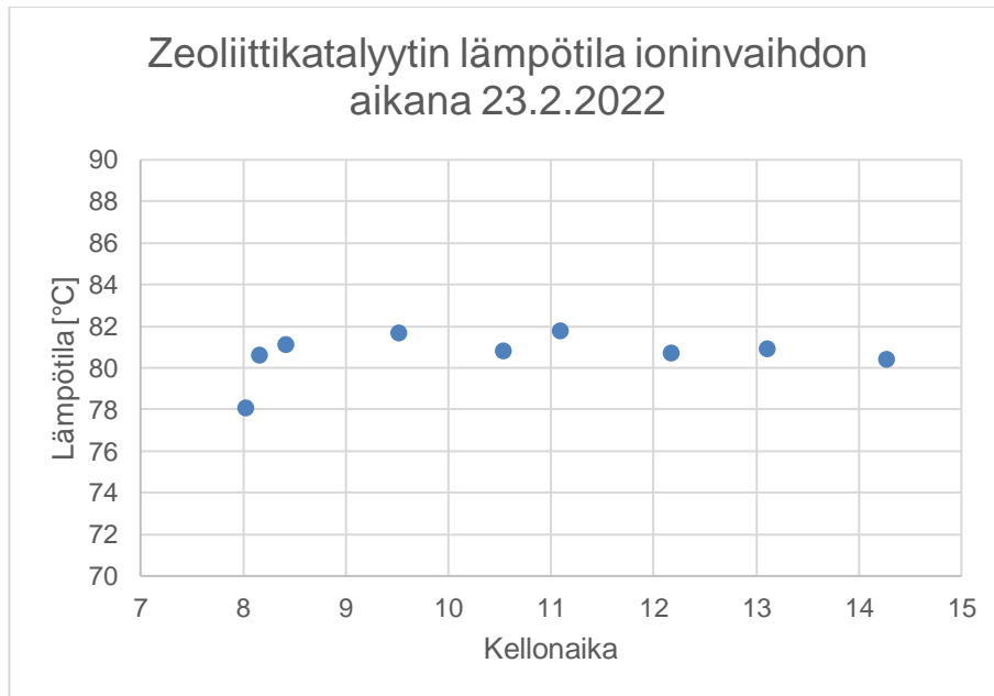
Kuva 3. Zeoliittikatalyytin lämpötila 23.2.2022 suoritetun ioninvaihdon aikana.
