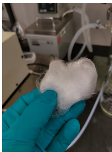
Kuva 13. Zeoliitin päälle laitettava lasivilla.
