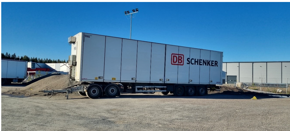
Kuva 7. Apuvaunuun kytketty kylkiaukeava puoliperävaunu lämmitinlaitteella varustettuna
