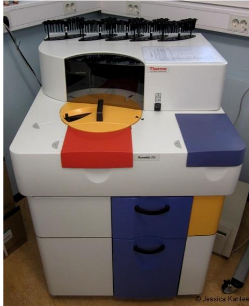
Kuvio 2. Konelab™ 20i -laite. Laitteen päällä rivissä mustat segmentit, joihin näytekyvetit tai –putket asetetaan.
