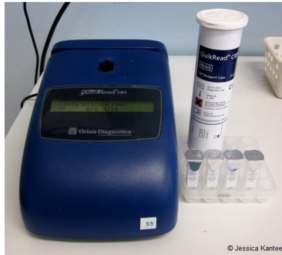
Kuvio 1. QuikRead ® 101 -vieritestilaite, reagenssikorkit (putken sisällä) ja puskuria sisältävät kyvetit.
