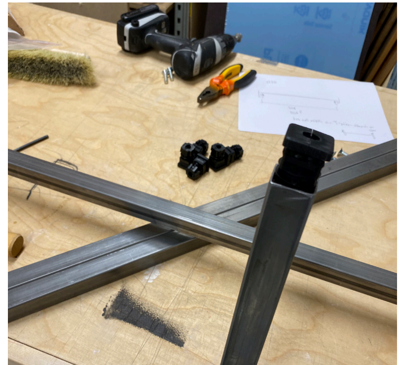
Kuva 61. Kierteellisten tulppien kiinnitys sarjoihin (Lahdentausta 2022)
