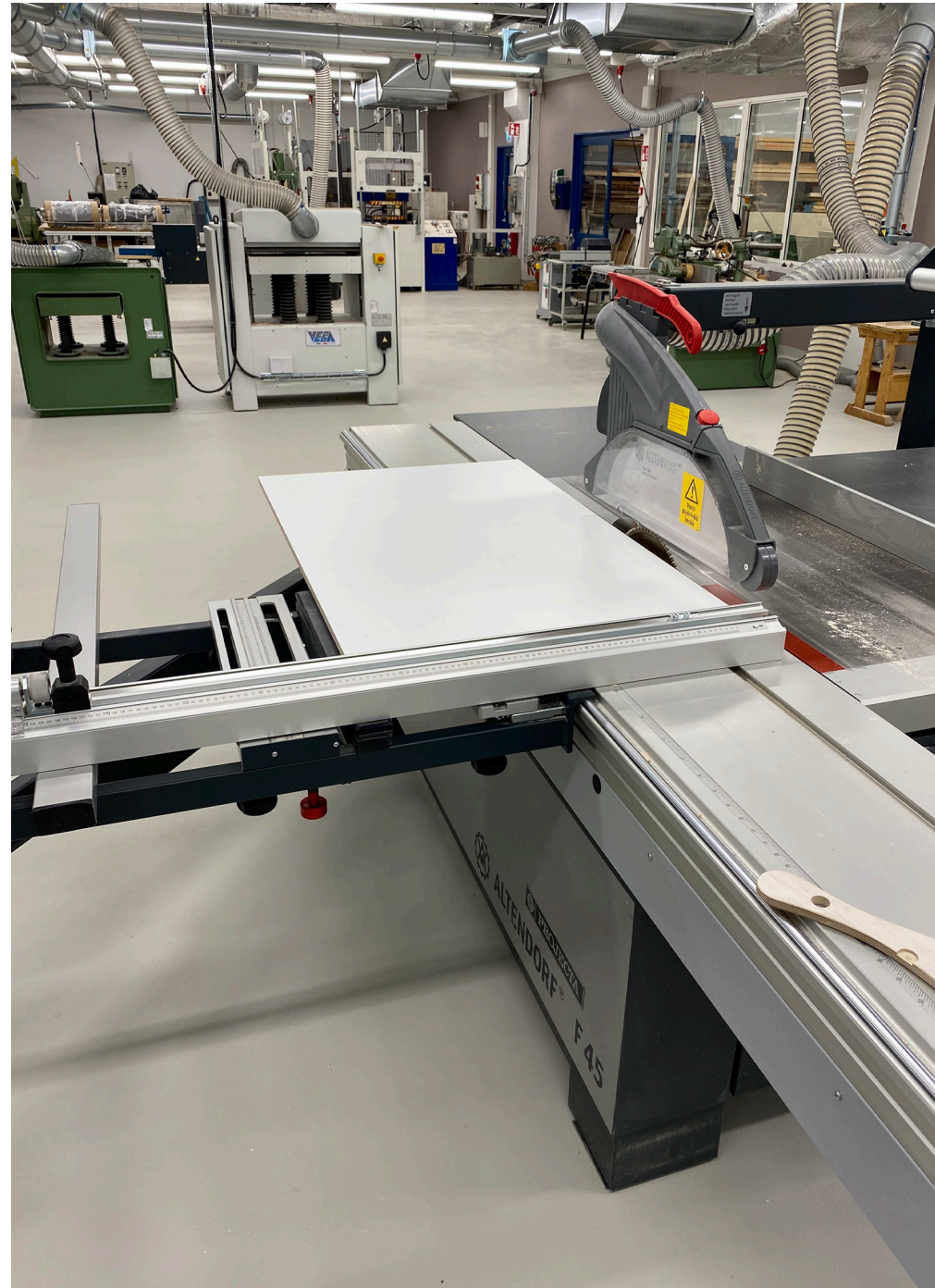
Kuva 66. Kansilevyn sahaus mittaan (Lahdentausta 2022)
