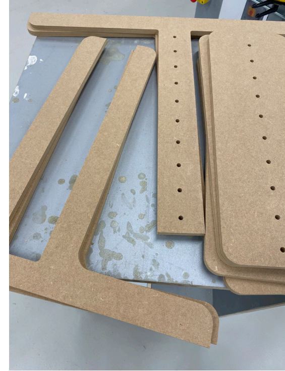
Kuva 47. Osat levyistä ulos jyrsinnän jälkeen (Lahdentausta 2022)
