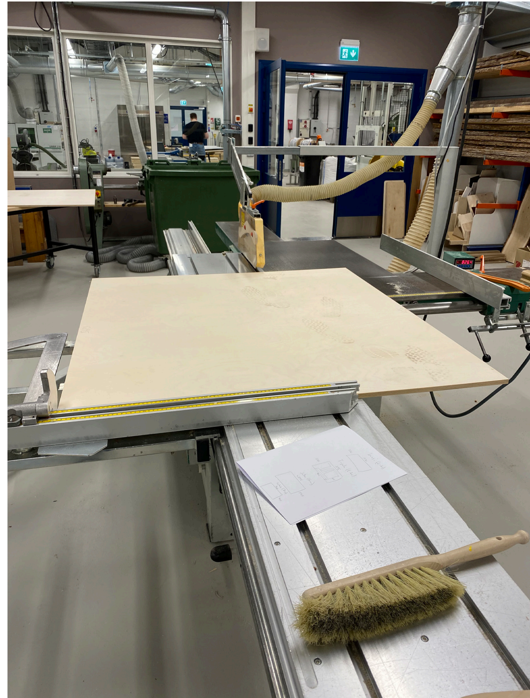
Kuva 53. Levyjen sahaus aihioiksi (Lahdentausta 2022)
