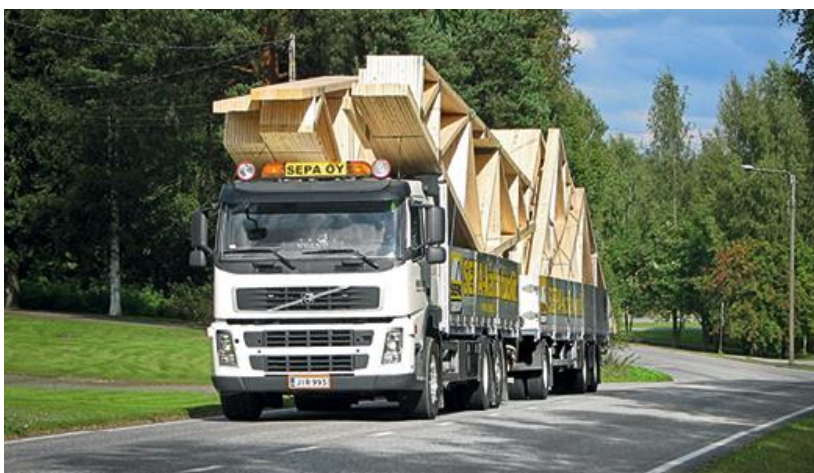
KUVA 25. Kattoristikkuorma. (Sepa Oy n.d.)
