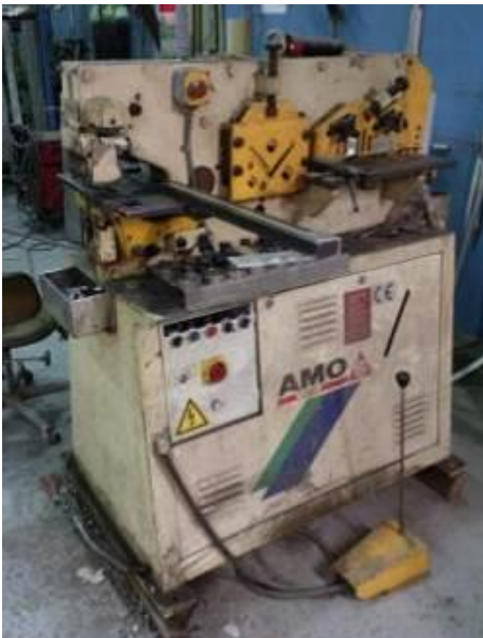
KUVA 9. Reiitytys- ja katkaisukone AMO
