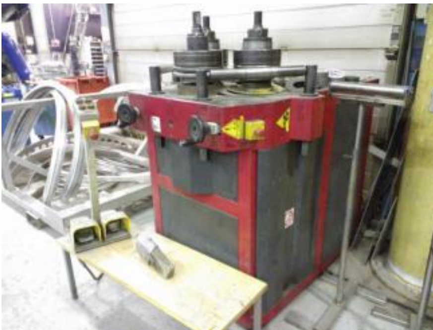
KUVA 5. Muotorautamankeli ALFA 70 H2
