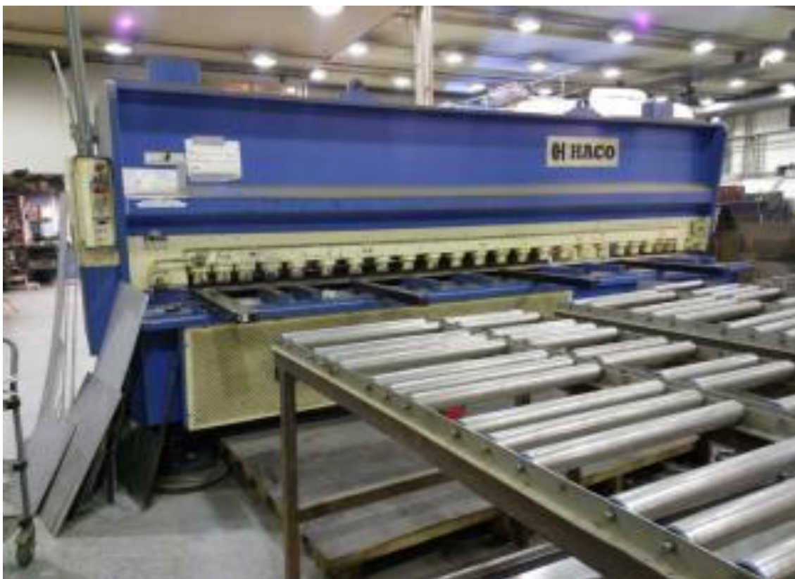
KUVA 1. Levyleikkuri HACO HSL 4010
