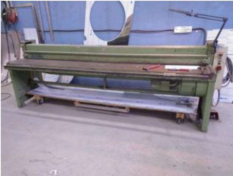
KUVA 2. Ohutlevyleikkuri SCHECHTL D-8094
