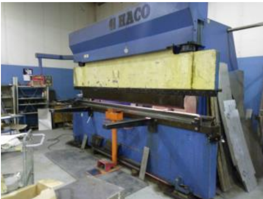
KUVA 3. Särmäyspuristin HACO PPM 40200
