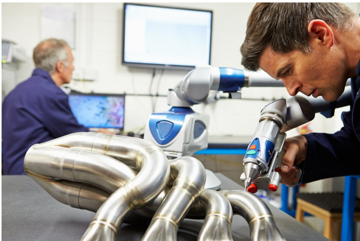
Kuva 14 CMM-koneella tarkastetaan koneen osan
