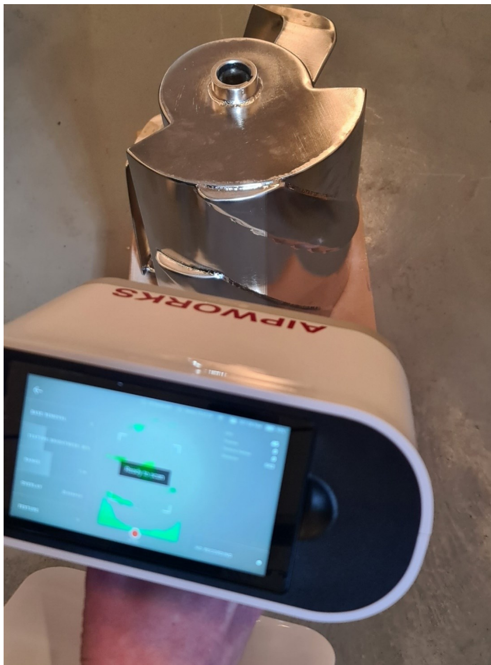
Kuva 28, Skannauksen yritys ilman pinnalle suihkutettua kehitettä (Vartiainen 2022, CC BY-NC)
