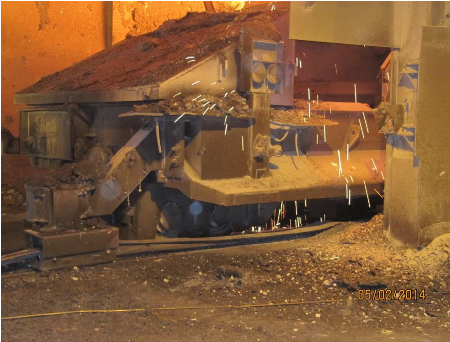
KUVA 13. Sulan roiskuminen teräksen kaadossa
