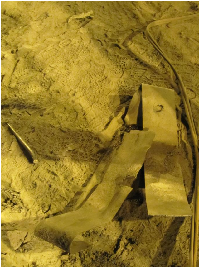
KUVA 12. Pahoin vääntynyt suojalatta
