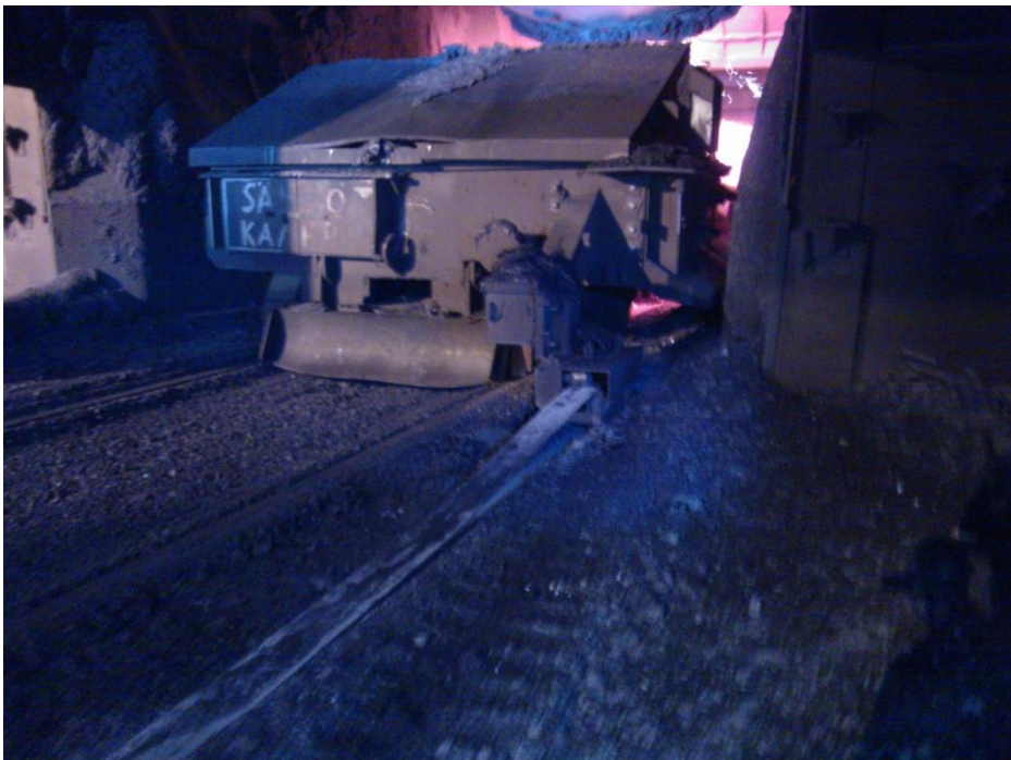
KUVA 14. Kuonan kaato konvertterista terässenkka-vaunussa olevaan kuonaseenkaan
