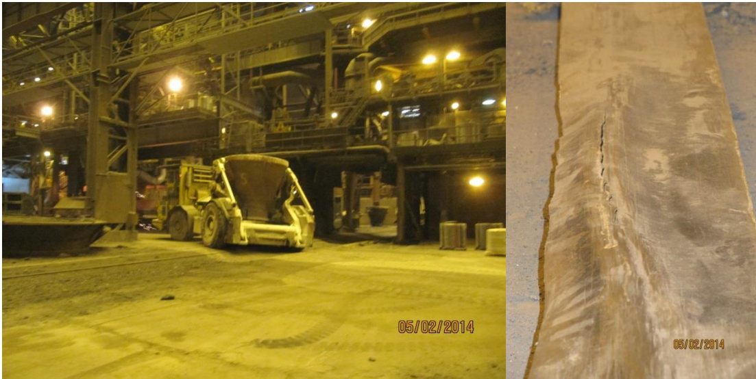
KUVA 16. Ylikulkupaikalla ajava kuonapata-auto ja ylikulkupaikalla vaurioitunut suojalatta
