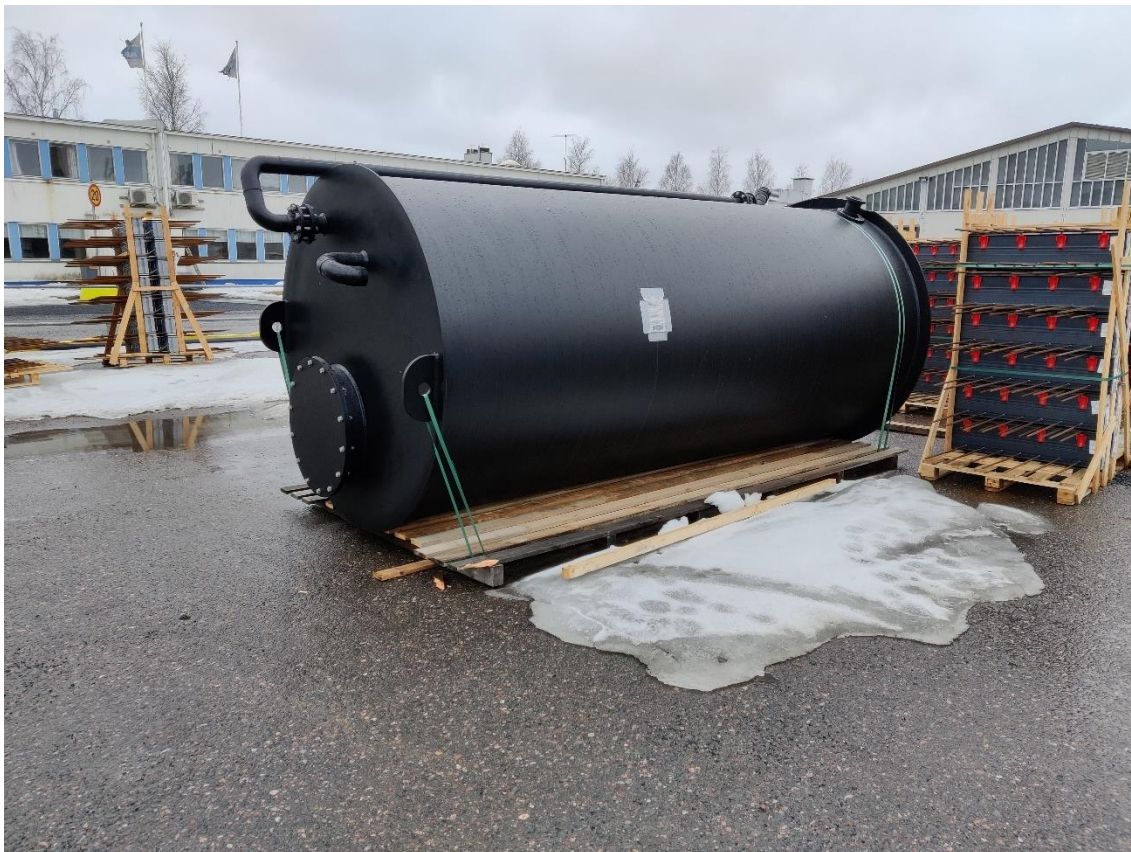
Kuva 1. Uusi lisäainesäiliö toimitettuna tehtaalle
