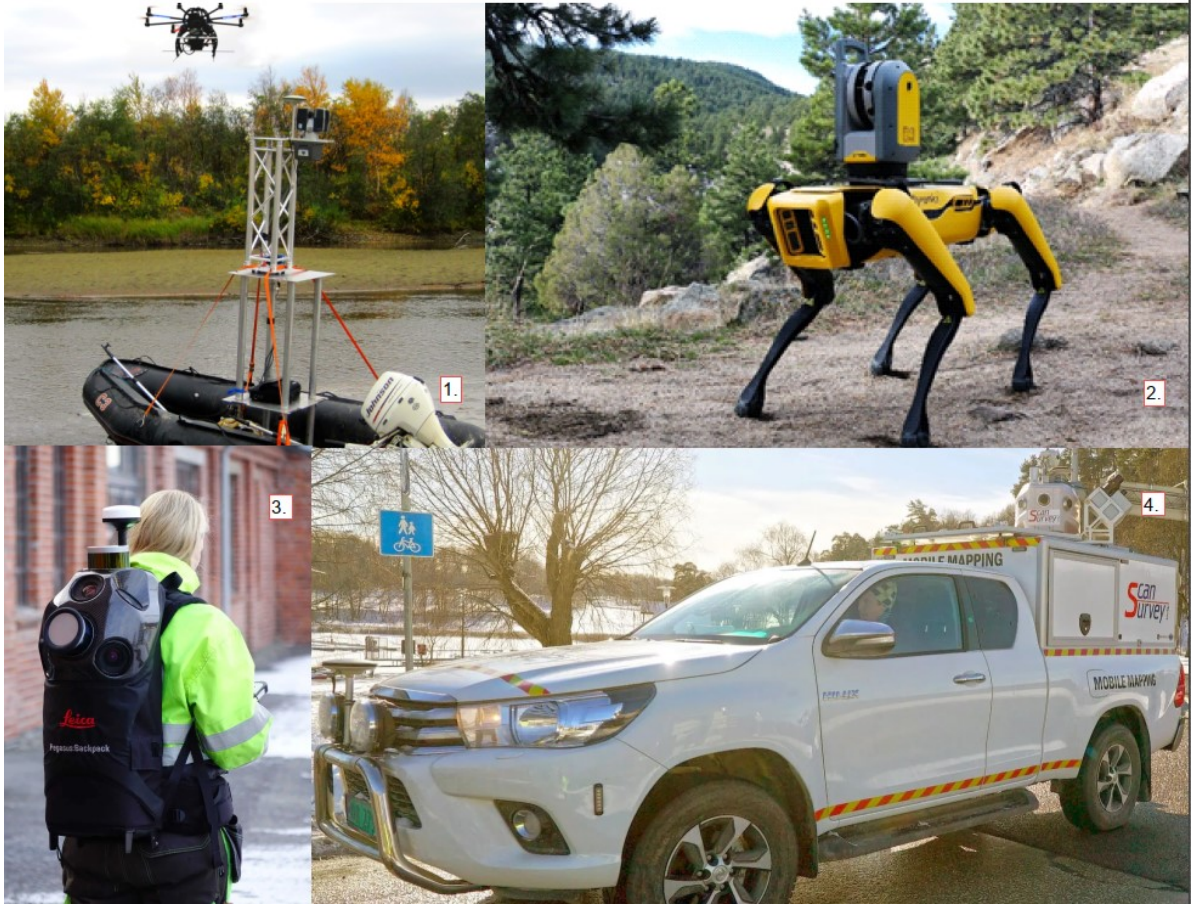
Kuva 3. Mobiilikeilauksessa vain mielikuvitus on rajana. 1. Laserkeilausta kumiveneellä sekä dronella. (Maanmittauslaitos 2022f) 2. Spot-robottikoira skannerin alustana. (Wired 2020) 3. Leica Pegasus-laserkeilausreppu. (Scan survey 2022) 4. Laserkeilain lava-auton katolla. (Scan survey 2022)
