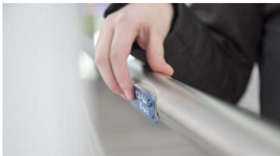
KUVA 22. Kaiteisiin asennettavista opasteista kulkija voi lukea missä kerroksessa ollaan (RT 91-11282 Kiinteistön opasteet 2017)
