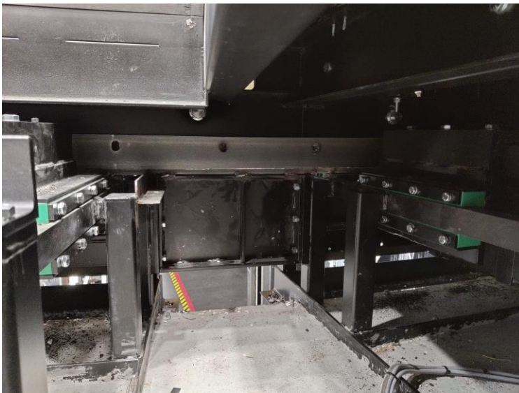
Kuva 18. Kehikko, jota vetopyörät pyörittävät.
