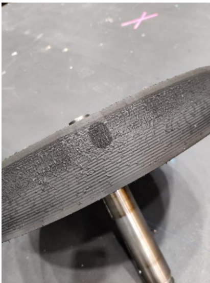
Kuva 20. Kehikon reikien jättämä jälki.
