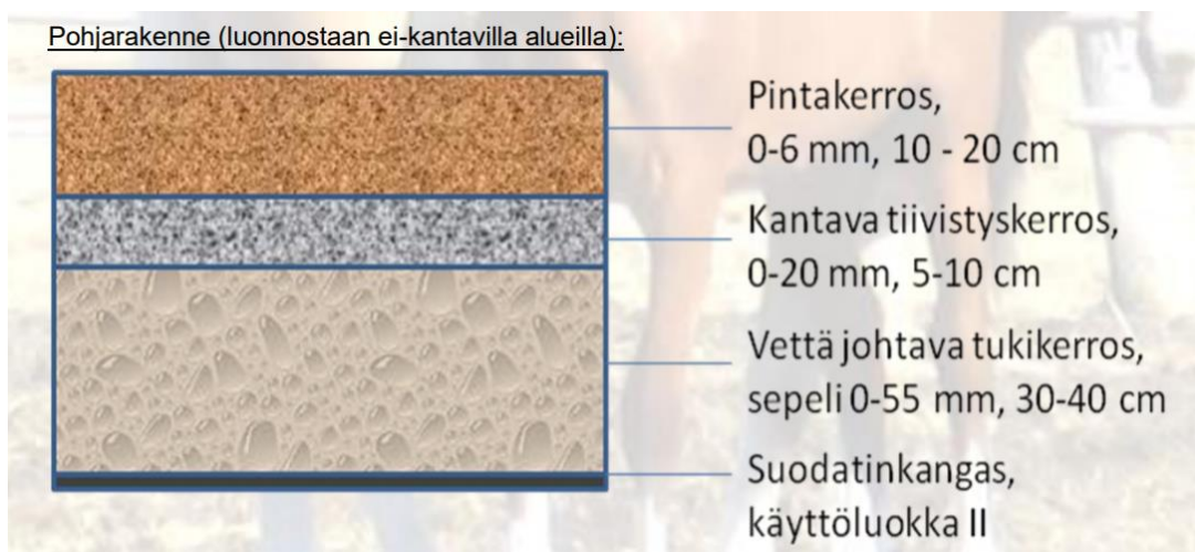
Figur 1: En lösning på bottenuppbyggnaden, HevosAgro-projektet (ProAgria Oulu, u.å.)
