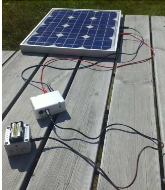
Kuva 15. Akkulaturin testaus 25 W:n aurinkopaneelilla
