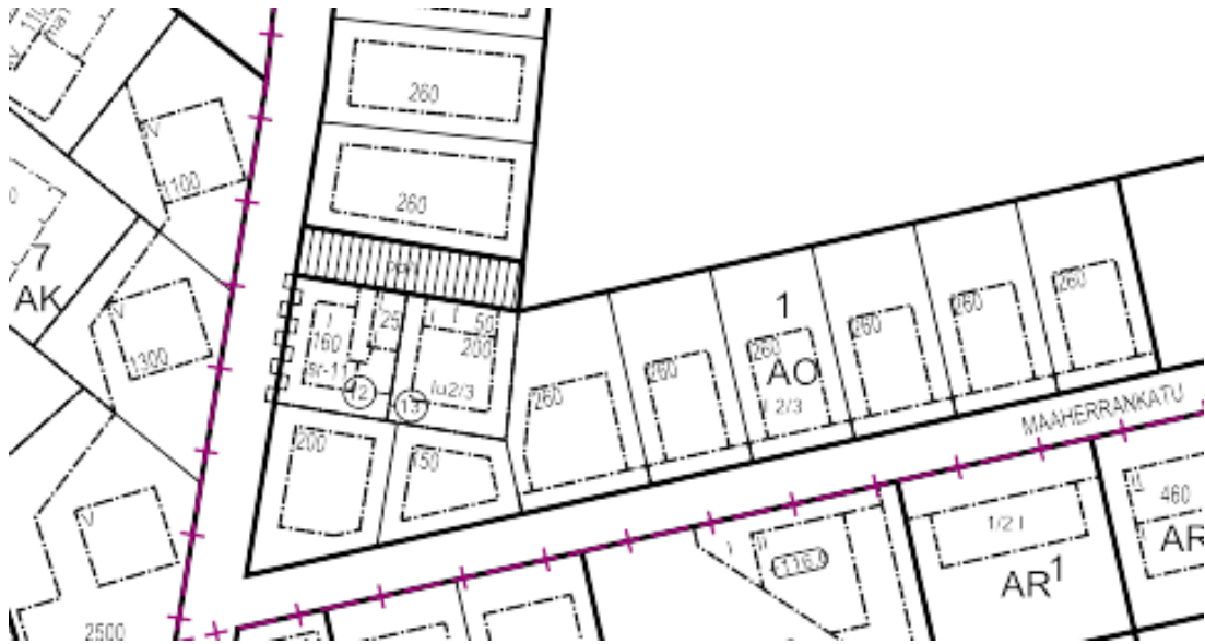
Kuva 2. Esimerkki Lappeenrannasta, jossa tontti lohkottu kahdeksi erilliseksi tontiksi (tontit 12 ja 13) sekä tehty niille sitova tonttijako. Ympärillä vanhan asema- makaavan mukainen ohjeellinen tonttijako (8).
