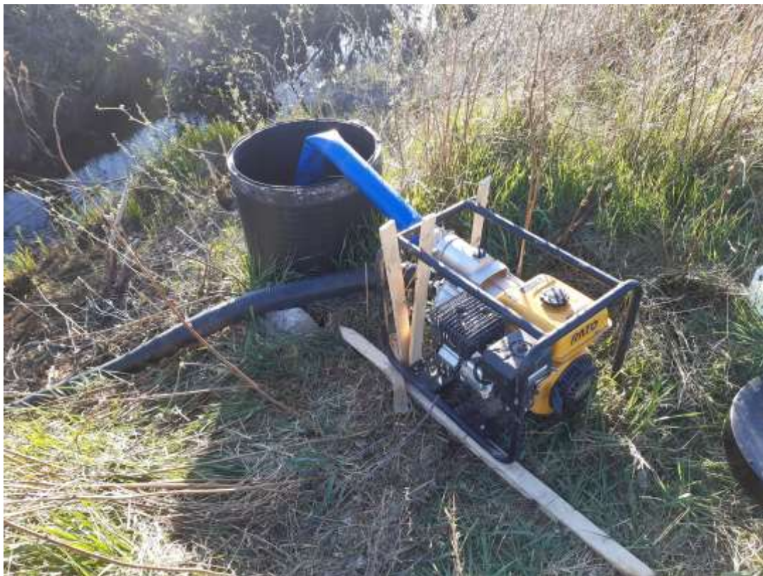
Figur 5. Underbevattning med bensindriven vattenpump (bild: Marcus Gjåls).
