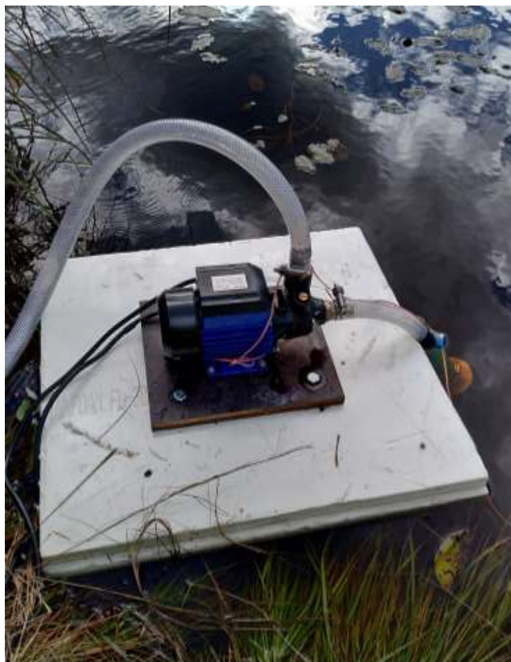
Figur 12. Vattenpumpen monterad på en flotte.
