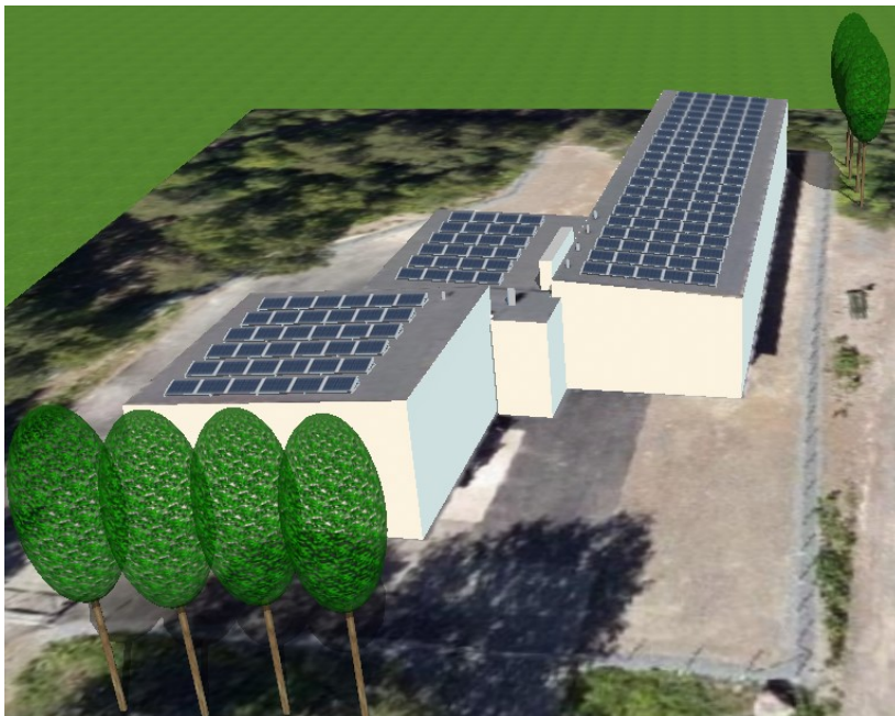
Kuva 14. Pvsol-premium ohjelmalla luotu mallinnus Onttolan alkalointilaitoksen aurinkoenergiajärjestelmästä
