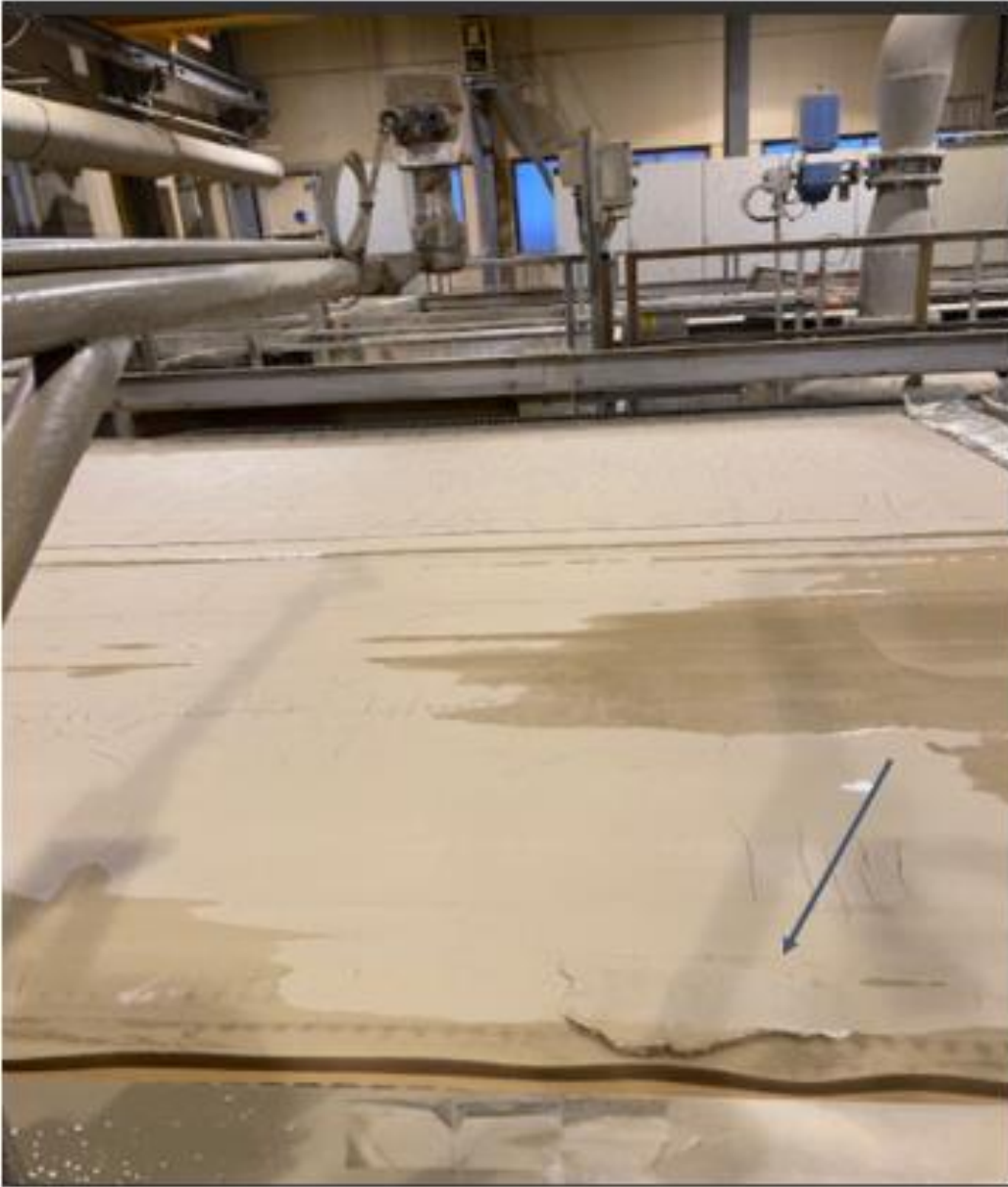
KUVA 12. Kakunpaksuustutka mittaa keskiarvopaksuutta 7 asteen kulmassa tasoon nähden
