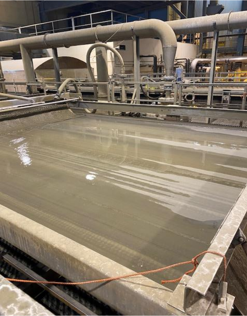
KUVA 16. Jarosiitin nauhasuodatin lietetiheyden säädön kanssa
