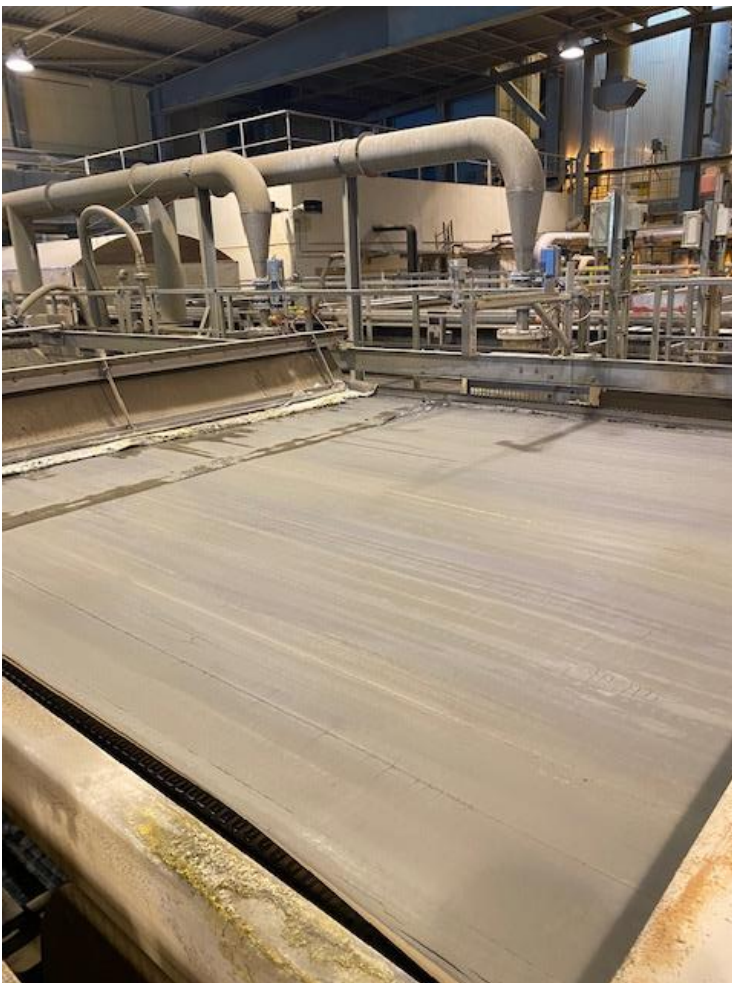
KUVA 15. Kiintoainekerroksen vahvuus jarosiitin nauhasuodattimella säätimen kanssa
