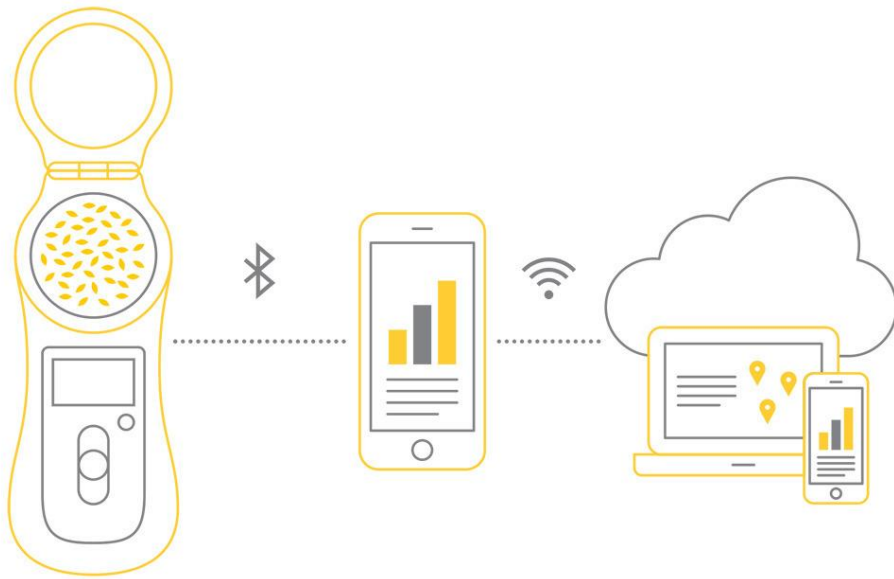
Kuva 13. GrainSense-mittauslaitteen toimintakaavio (Partti, 2019).
