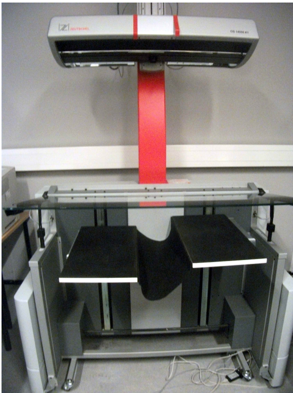
Mastoskanneri max. 500 mm paksuille sidoksille
