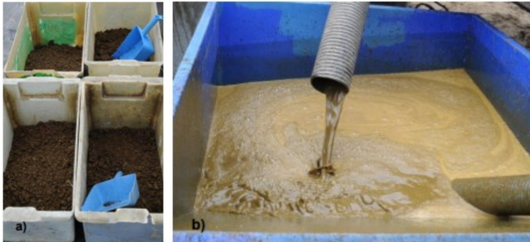
KUVIO 20. Mädätysjäännöksestä separoitua a) kuiva- ja b) nestejajetta (Virkajärvi ym. 2016, 27)
