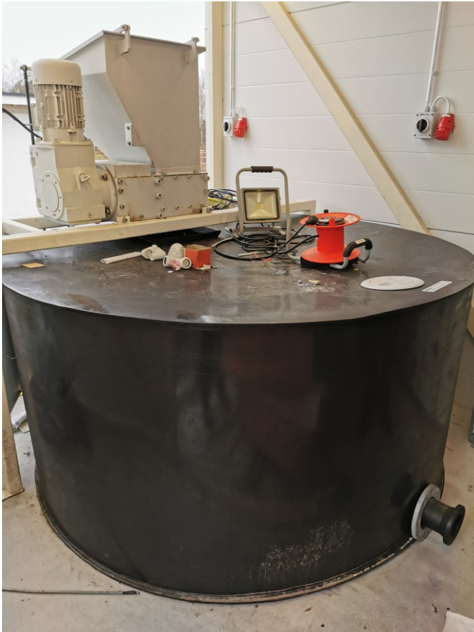
KUVIO 31. Esisäiliö ja murskain Louen biokaasulaitoksella (Kuva: Elisa Lääkkölä)
