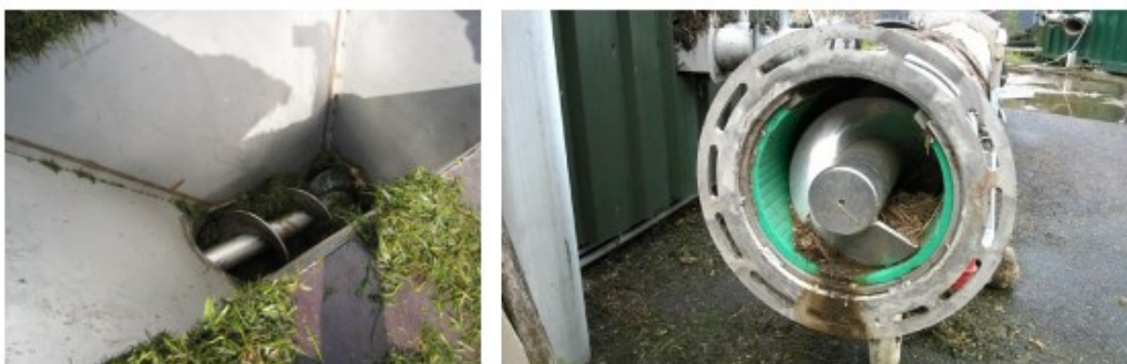
KUVIO 5. Biomassan hienontaminen ja kuljettaminen ruuvitekniikalla (Luostarinen & Jaakkola 2015, 49)
