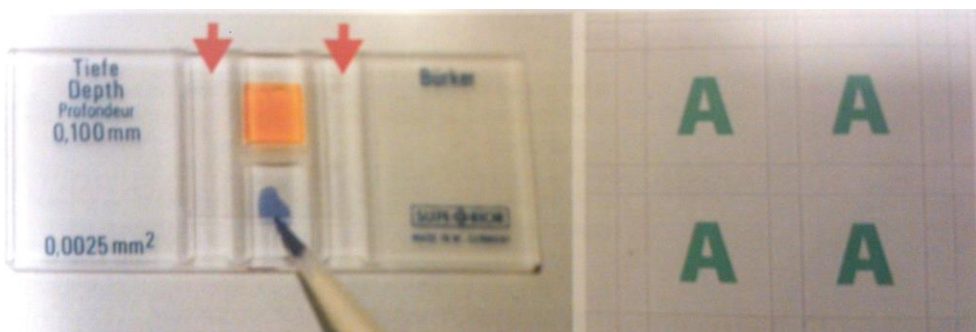
Kuva 7. Bürker-kammio ja mikroskooppinäkymä ruuduista. A=laskentaruutu. (Sojakka & Välimäki 2011: 152)
