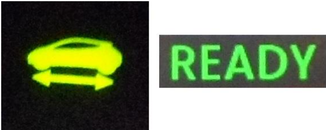
Kuva 11. Liikkeellelähtövalmiuden ilmaiseva merkkivalo Nissan Leafissa ja VW Jetta hybridissä.
