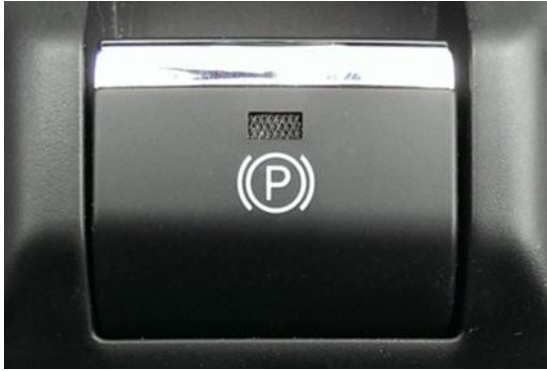
Kuva 12. Sähköisen seisontajarrun katkaisin ja symboli [10, s. 25].
