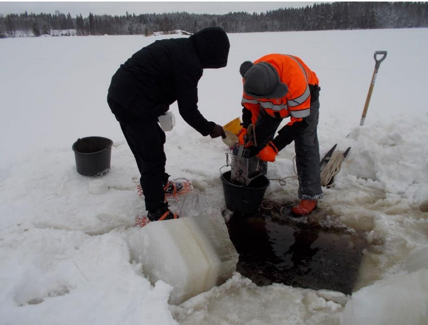
Kuva 15. Järven pohjaeläinnäyte on juuri otettu Ekman-tyyppisellä noutimella Kerimäen (Savonlinna) Kuonanjärvellä huhtikuussa 2018. Kuva: Joanna Latoszek.
