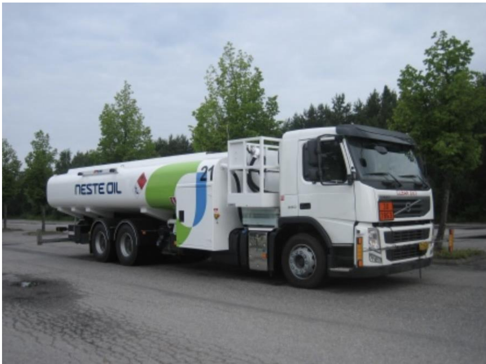
KUVA 1, Jet-Teknon valmistama kiinteäsäiliöinen painetankkausajoneuvo (Airportindustry-News n.d.)
