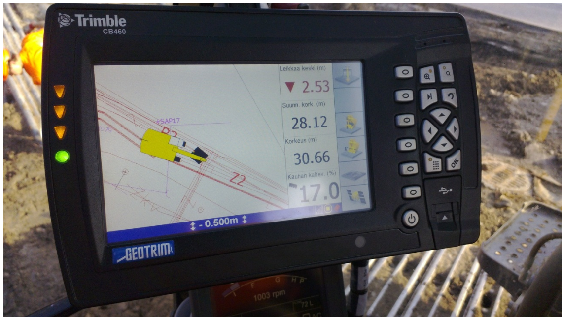
Kuva 17 Kaivinkoneen kuljettajan näkymä. Vasemmassa reunassa olevat valot osoittavat suuntaa kauhasta malliin. Kun kauha on tasan mallin korkeustasossa, palaa vain vihreä LED. Sama etäisyys näkyy numeraalisti näytön oikeassa yläkulmassa. (Kuva: Mattijaakko Määttänen)
