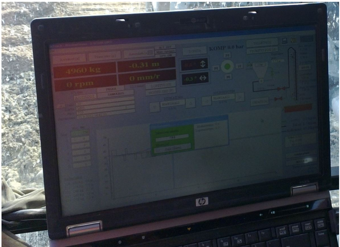
Kuva 13 Stabilointikoneen koneohjausyksikön pc, joka ohjaa puomia ja sideaineen syöttöä. (Kuva: Mattijaako Määttänen)
