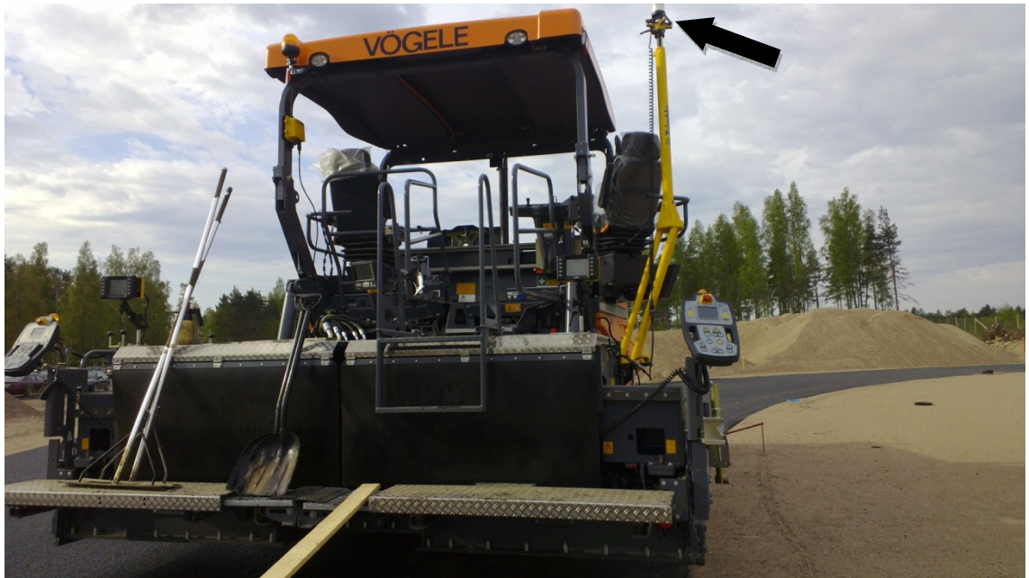
Kuva 15 Aktiiviprisman kiinnitys 3D-koneohjattuun asfaltinlevittimeen. (Kuva: Mattijaakko Määttänen)
