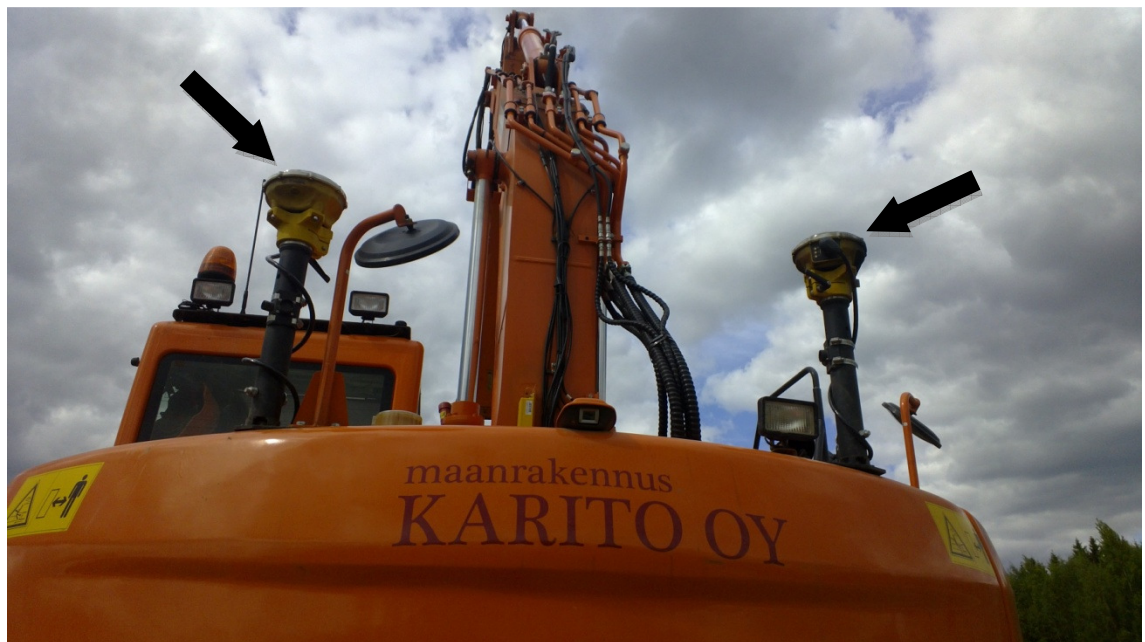
Kuva 14 GNSS-antennit kaivinkoneen peräpuntin päällä (Kuva: Mattijaakko Määttänen)
