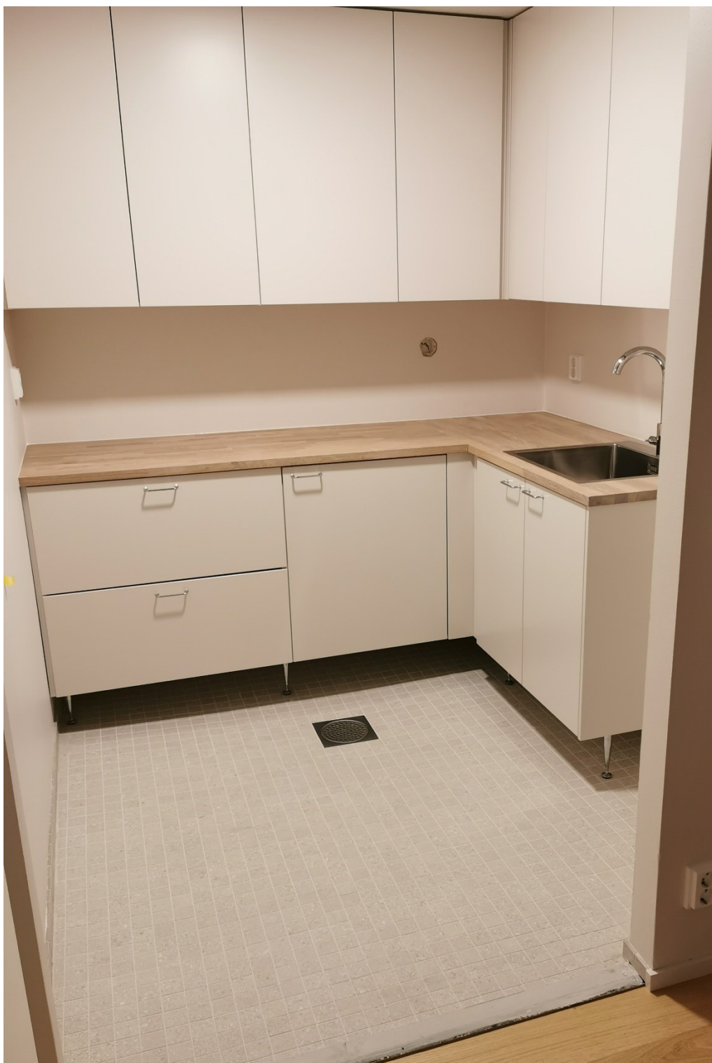
Kuva 3: Tässä kohteessa kaksi asuntoa yhdistettiin jo rakentamisvaiheessa yhdeksi isommaksi asunnoksi. Toisen asunto-osuuden kylpyhuone muutettiin kodinhoitohuoneeksi. Alkuperäisten tekniikkavarausten avulla voidaan tarvittaessa alkuperäinen asuntojako palauttaa.
