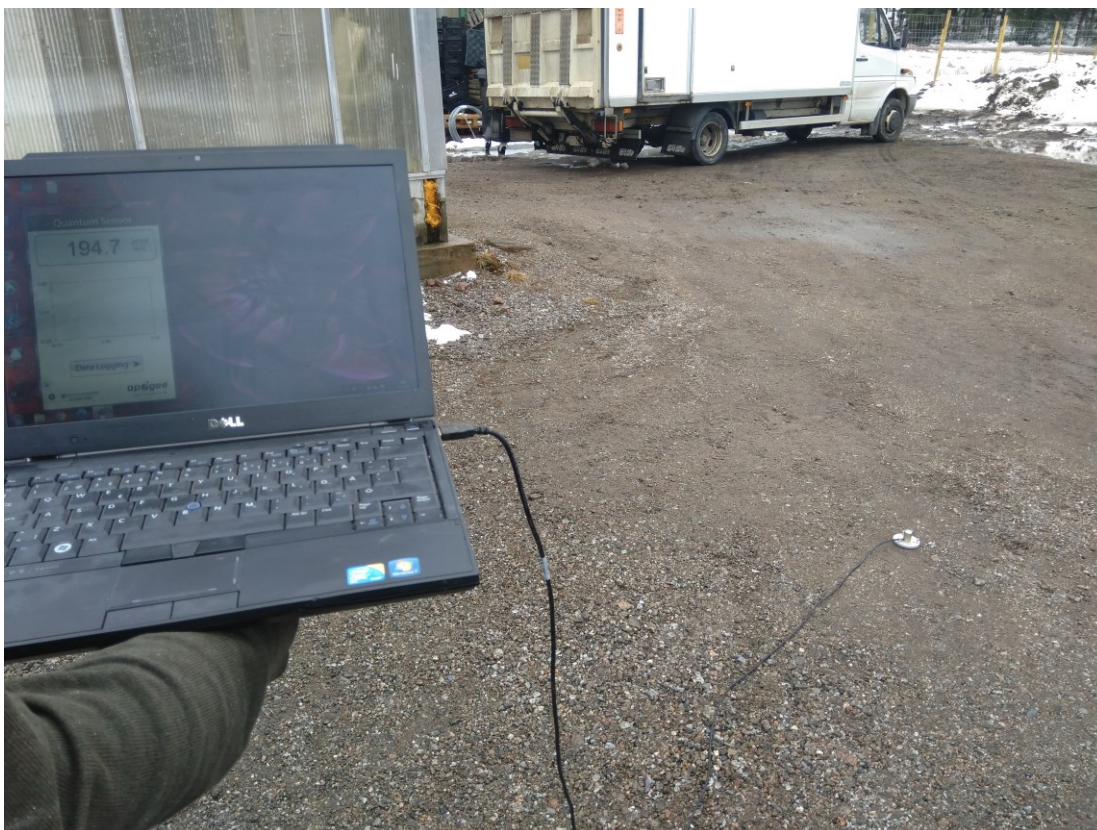
Kuva 28. Päivänvalonmittaus samalla säällä ulkona, tosin luultavasti hieman liian lähellä varjoa muodostavia ja mittausta häiritseviä kohteita. Näytöllä lukee arvo 194,7 \mu\text{mol}/\text{m}^2/\text{s} .
