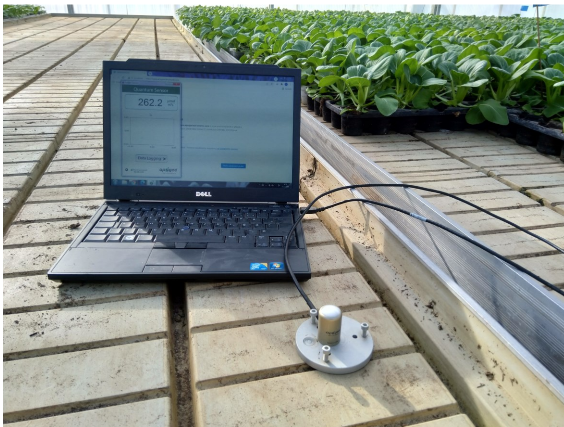
Kuva 26. Apogee-anturipää ja sen käyttöliittymä päivänvalon mittauksessa kasvihuoneen sisällä. Näytöllä lukee arvo 262,2 \mu\text{mol}/\text{m}^2/\text{s} .
