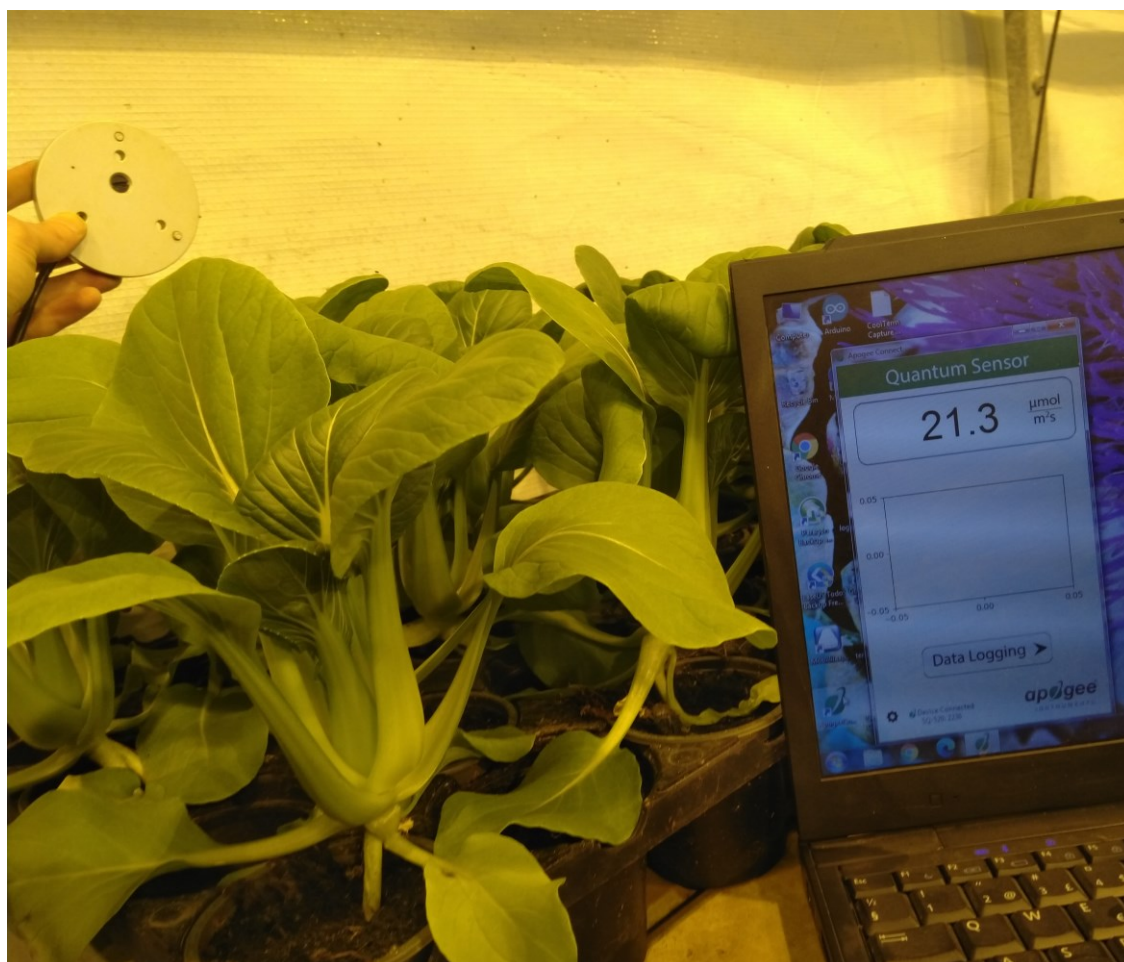
Kuva 24. Näin voidaan mitata seinän tai pinnan heijastamaa valoa, tässä tapauksessa kasvihuoneen pimennysverhojen heijastavuutta. Mittauksessa anturi seuraavaksi käännetään ja mitataan seinää kohti saapuvaa valoa.
