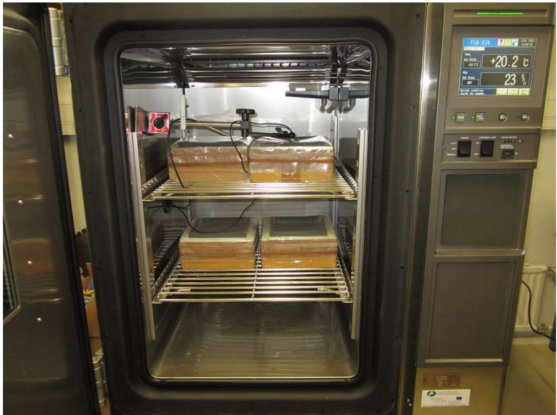
Kuva 17. Neljä koekappaletta jäädytys-sulatuskaapissa
