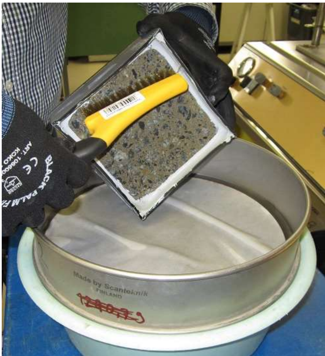
Kuva 21. Harjaus suoritetaan messinkiharjalla ja huuhtelu suihkupullolla.
