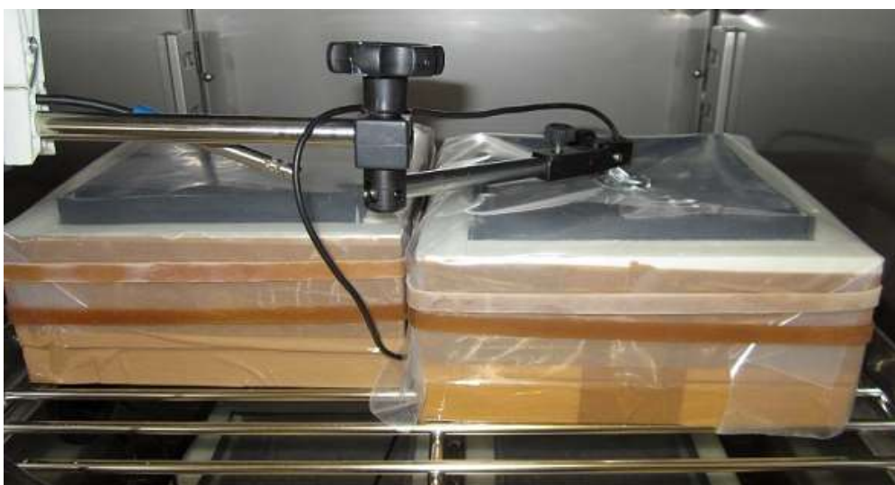
Kuva 16. Koekappaleen testipinnan ja jäädytys-sulatuskaapin sisäilman dataloggerien lämpötila-anturit
