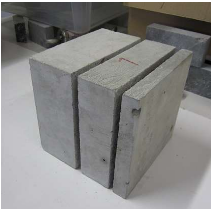
Kuva 10. Koekuutio sahauksen jälkeen, koekappale on keskimäinen "viipale"
