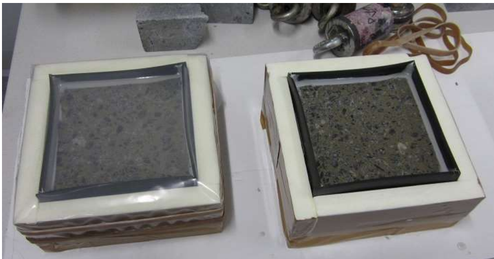
Kuva 15. Koekappaleiden valmistelua jäädytys-sulatussyklejä varten
