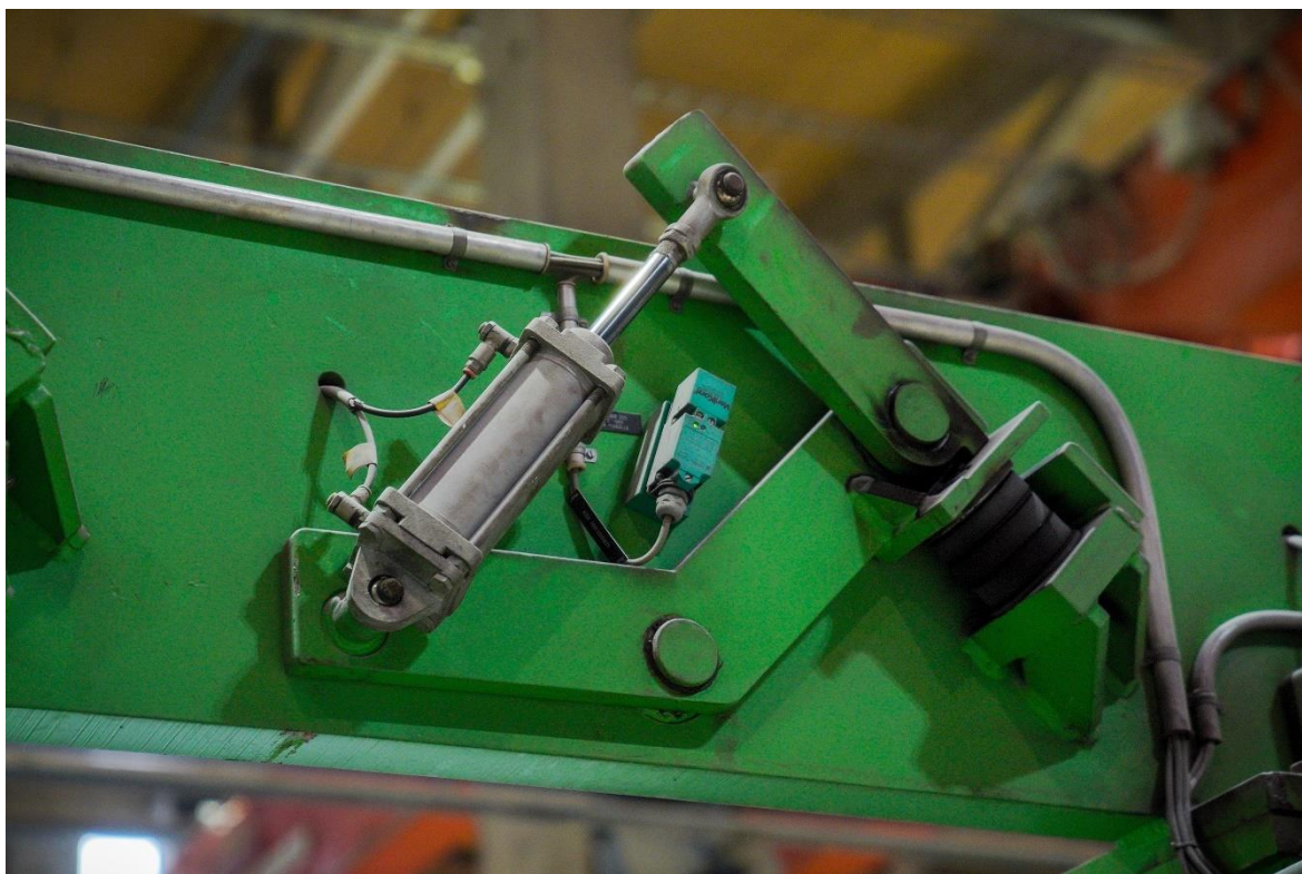
Kuva 3. Paineilmasyylinteri (Kuva: Santeri Leino)
