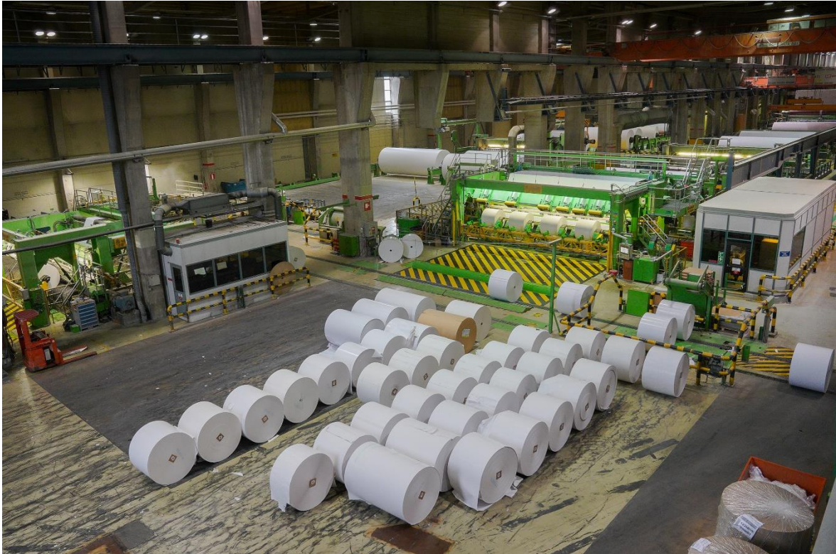
Kuva 11. Pituusleikkurilla pienemmäksi leikatut rullat (Kuva: Santeri Leino)
