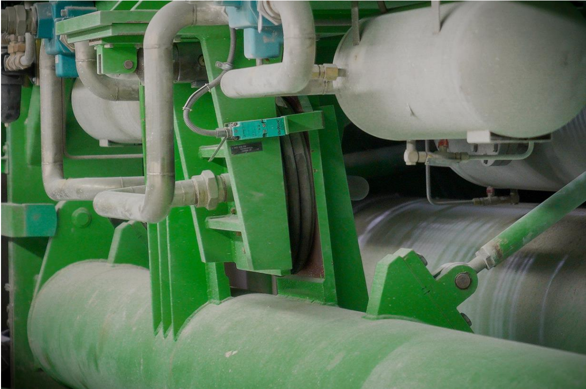
Kuva 4. Paljesylinteri kasaan puristettuna (Kuva: Santeri Leino)
