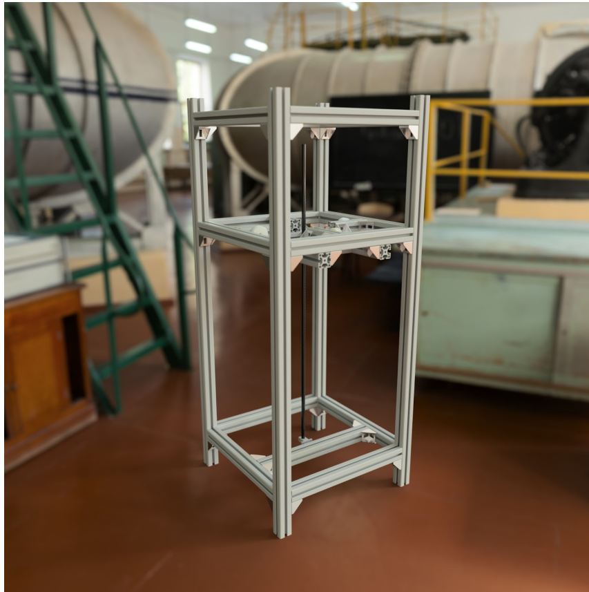
Figur 2.1: Visualisering av kalibreringsjigg för töjningsgivare
