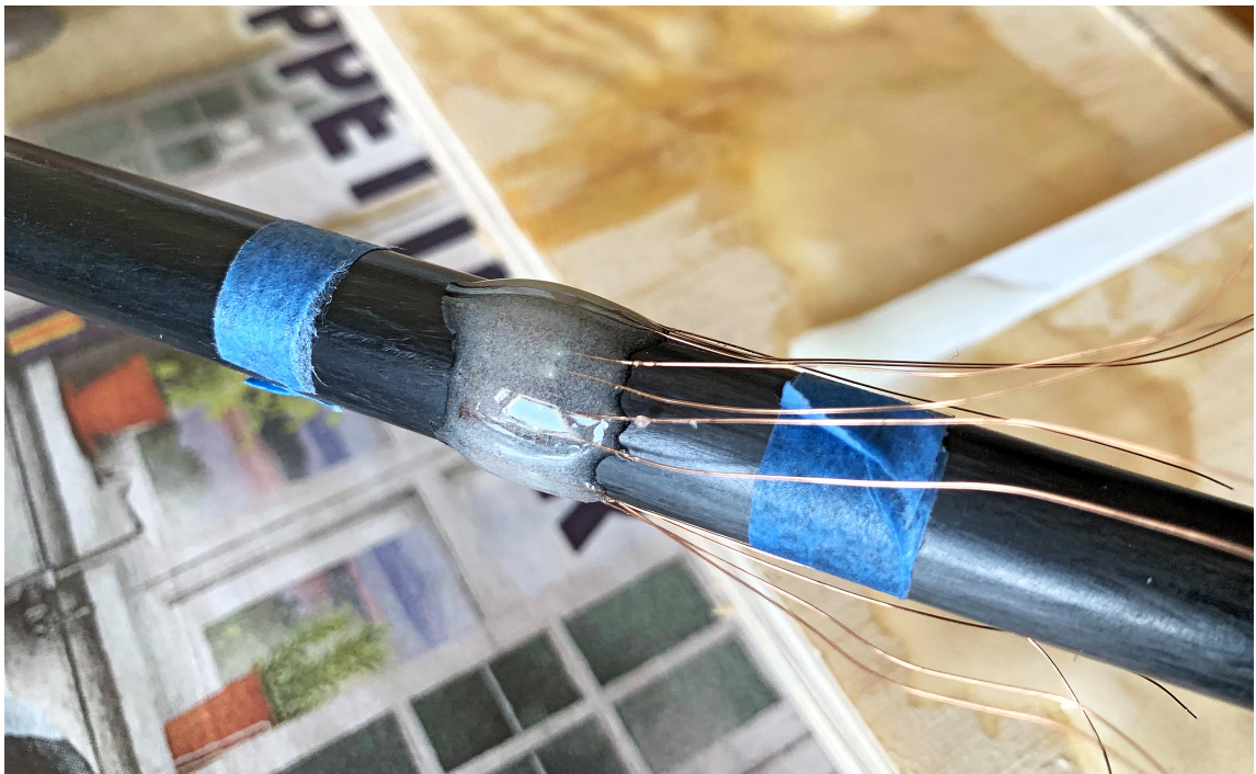
Figur 3.5: Ett skyddande epoxylager har applicerats på givarna
