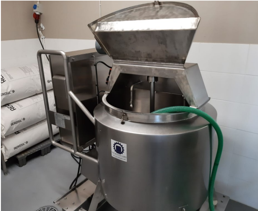
Kuva 22. Työn tilaajan hankkima sekoitussäiliö lapasekoittimella.
