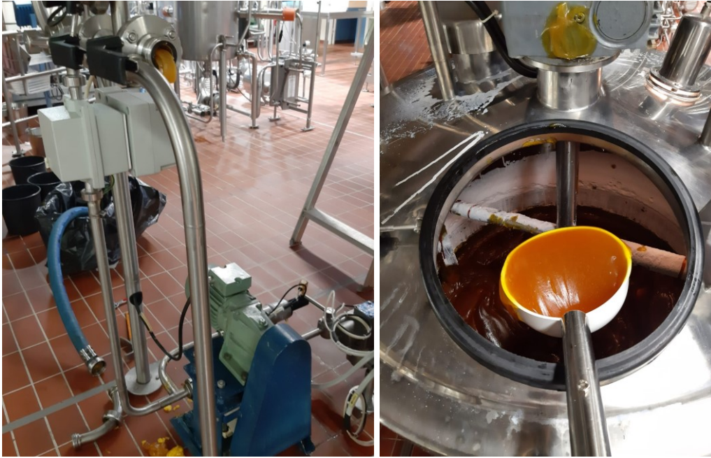
Kuva 19. Sekoitussäiliön pesu kiertopesujärjestelmällä.
