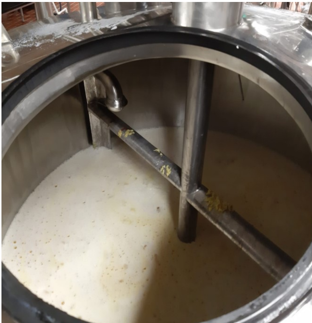
Kuva 19. Sekoitussäiliön pesu kiertopesujärjestelmällä.
