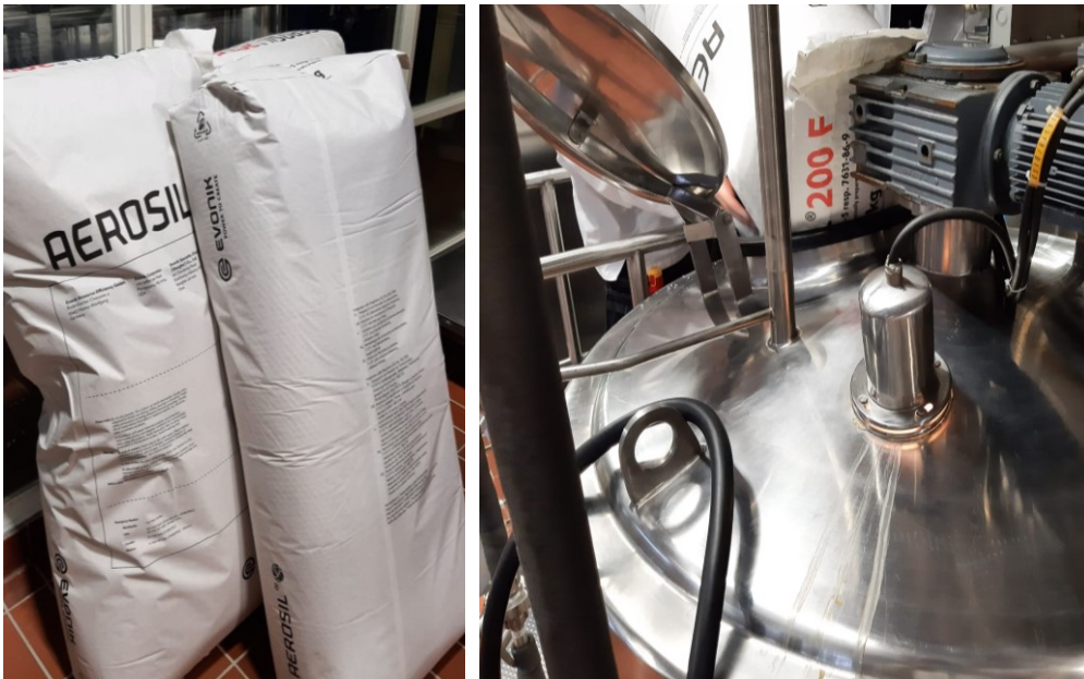
Kuva 14. Piidioksidi AEROSIL® 200 F ja piidioksidin annostelu sekoitussäiliöön A.
