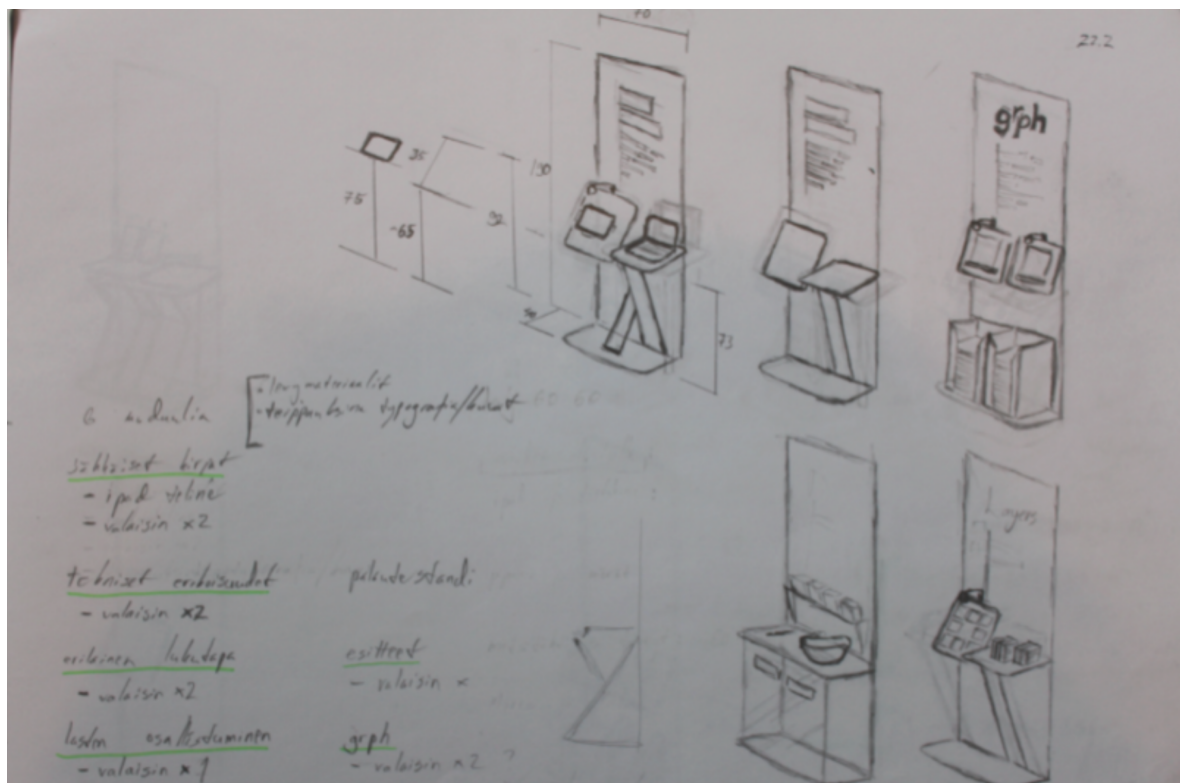
Kuvio 12. Lopullinen runkomalli mittoineen sekä kirjaparikohtaiset rakenneluonnokset.
