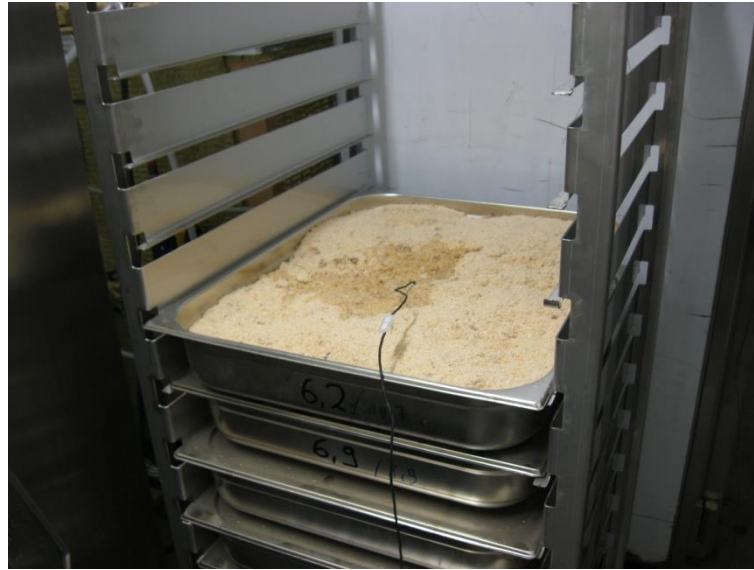
Kuva 15. Yksityiskohta termoparin asentamisesta sahajauhoon
