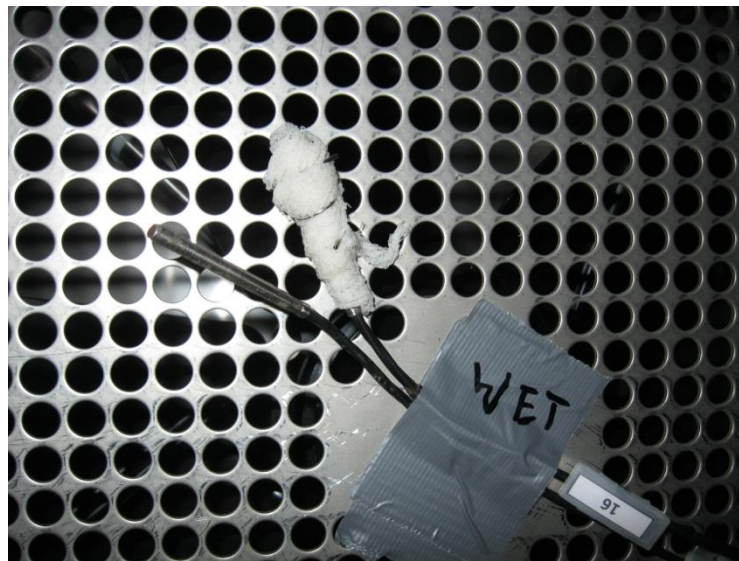
Kuva 16. Kuiva- ja märkälämpömittari höyrystimen imupuolella
