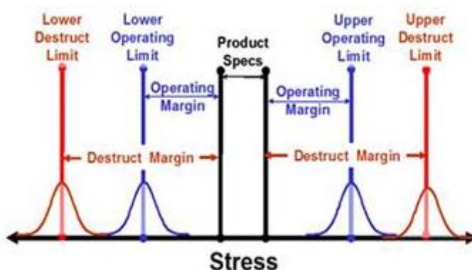
Figur 4. Perspektiv över en HALT-procedur. (intertek, 2020).
