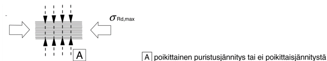
Kuva 17. Puristussauvan mitoituslujuus, kun sauvassa ei esiinny poikittaisia vetojännityksiä (SFS-EN 1992-1-1 + A1 + AC 2015, s. 105).
