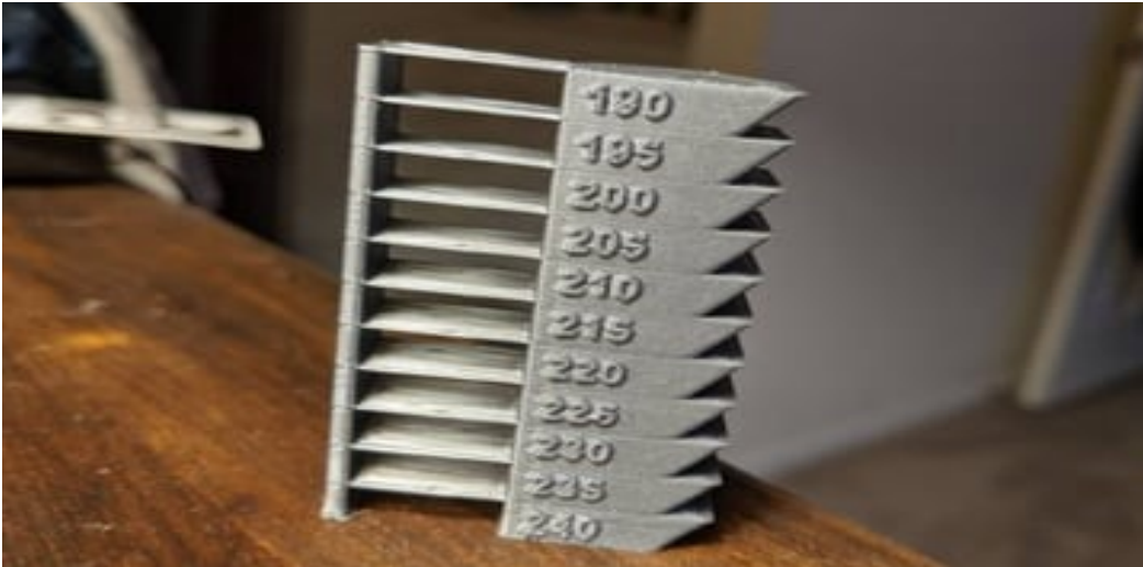
Kuva 5. Suuttimen lämpötilatorni. (O'Connell, 2021).
