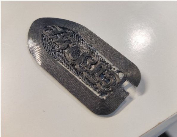
Kuva 25. Simplify3D käyttää takaisinvedossa syöttönopeutta 2,60 mm ja nopeus on 25 mm/s. Tämän kuvan malli on tehty CraftWarella syöttönopeudella 0,15 mm ja nopeus on 15 mm/s
