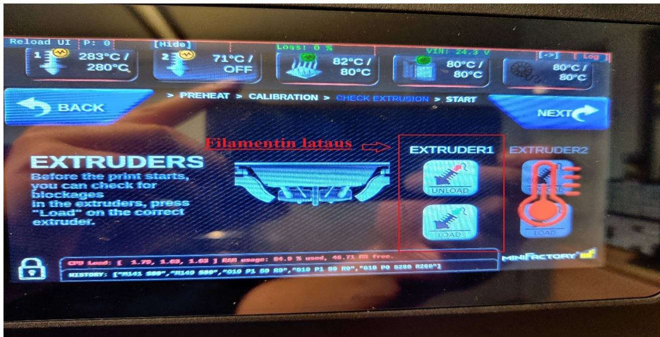
Kuva 19. Filamentin viime hetken lataaminen ennen tulostamista. Ylärivillä voidaan todentaa 1. Suutin 1 lämpö, 2. Suutin 2 lämpö, 3. Pedin lämpö, 4. Tulostuskammion lämpötila ja 5. Tulostuslangan kammion lämpötila.
