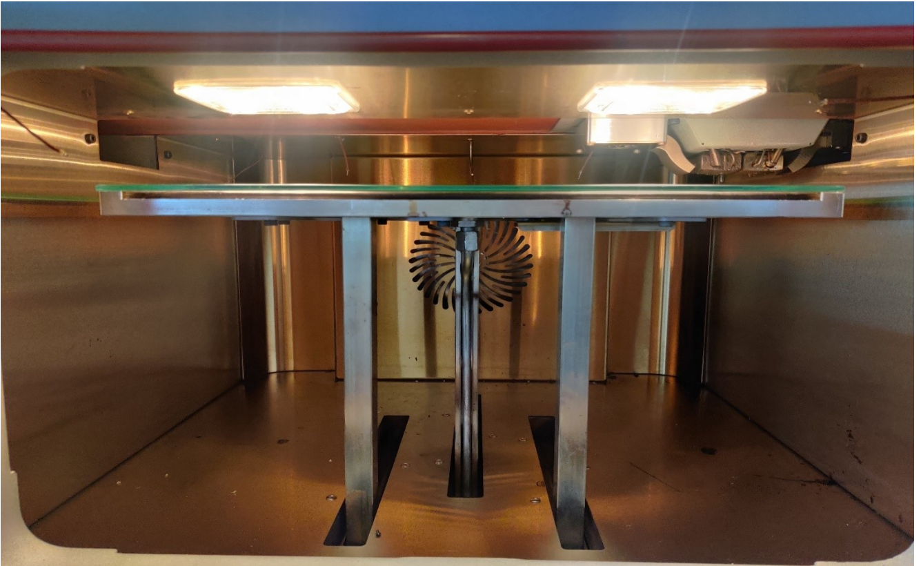
Kuva 17. miniFactory Ultram tulostuskammio on ruostumatonta terästä.
