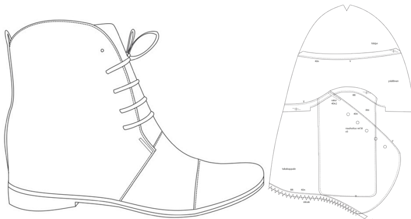
Kuva 38. ProjectNEXT –malliston varrellisen derbyn viivapiirros sekä räjäytetty kuva. Illustrator.
