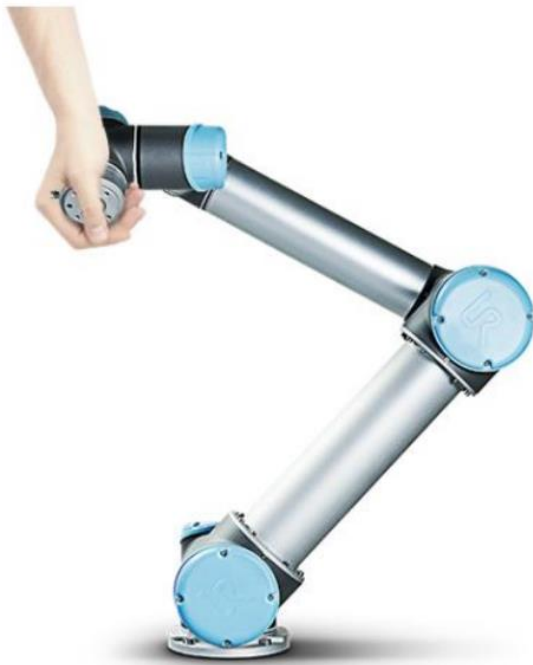
Kuva 10. Liikeradan opettaminen yhteistyörobotille (Robotiikka 2016, [Viitattu 20.4.2022]).
