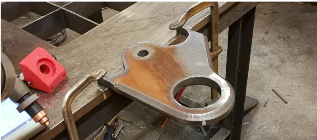
Kuva 36. Tuotannon osan F683266 viistettynä robotilla.
