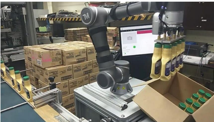
Kuva 15. Techman yhteityörobotti pakkaamassa tuotteita (Buchert 2021).
