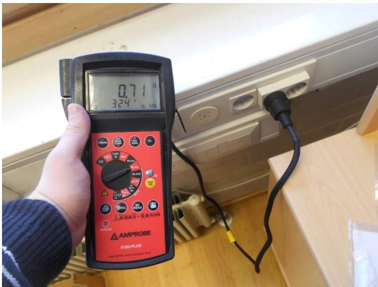
KUVA 21. Syötön automaattisen poiskytkennän testaus pistorasiaryhmästä
