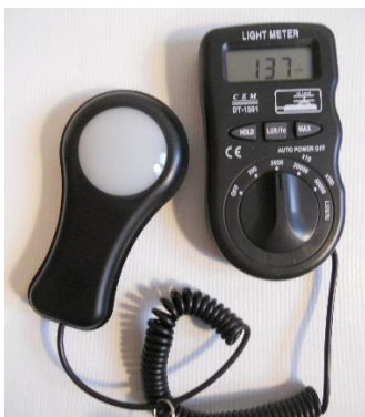
KUVA 26. CEM DT-1301 -luksimittari
