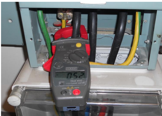
KUVA 16. Virtojen mittausta pihtimittarin avulla
