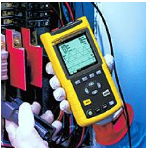
KUVA 17. Fluke 43B -sähkönlaadun analysaattori (Kuva: Fluke)
