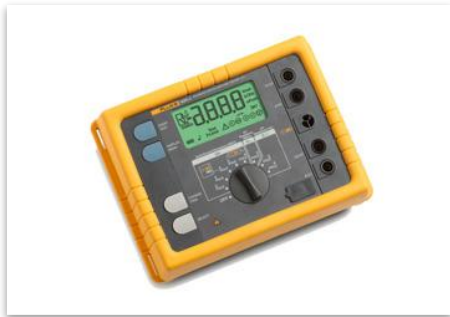
KUVA 25. Fluke 1652-2 GEO -maadoitusvastustesteri (Kuva: Fluke)
