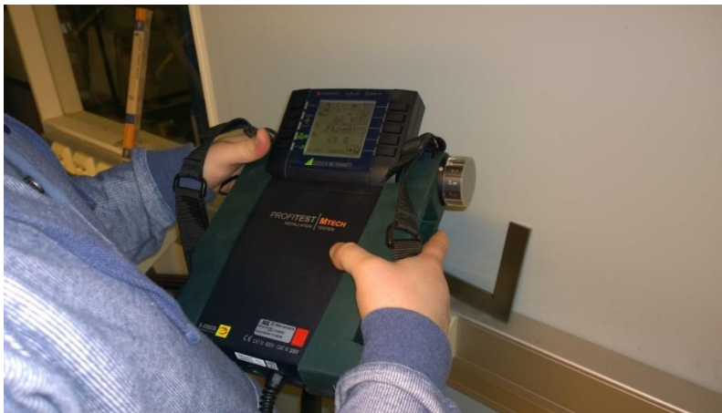
KUVA 24. Vikavirtasuojan toimintavirran mittaus (Kuva: Mika Koskinen 2014)
