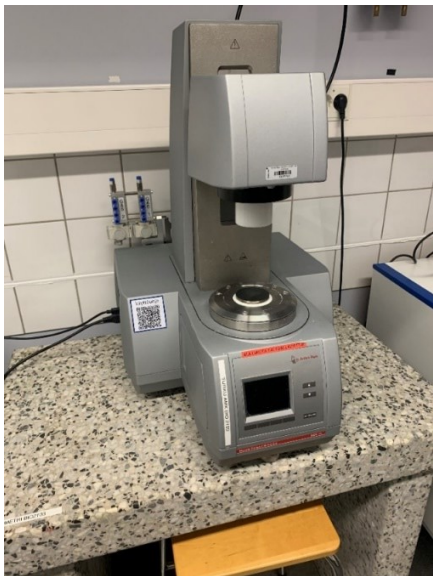
Kuva 12. Turku AMK:n Anton Paarin valmistama reometri
