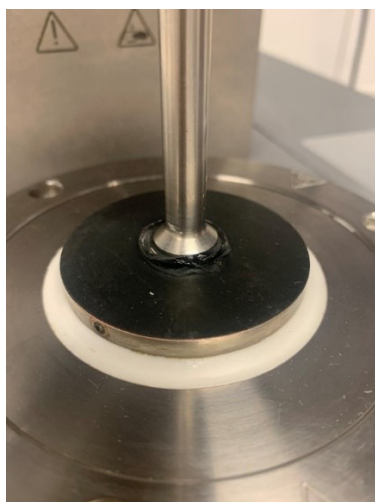
Kuva 13. Reometrin taso-taso geometria
