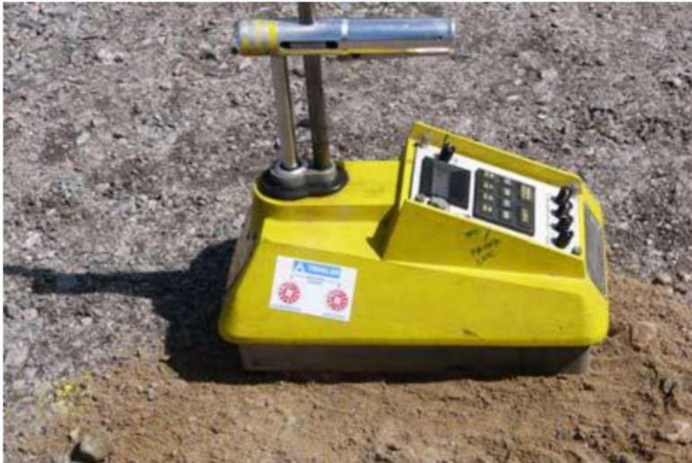
Kuva 4. Troxler-mittaus maaperästä. (Juutinen, 2015)
