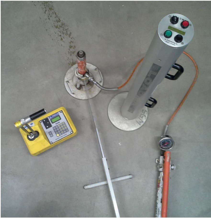
Kuva 7. Loadman, Troxler, levykuormituslaitteisto. (SGM Consulting)
