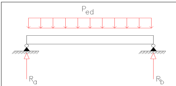
Figur 8. Fritt upplagd tvåstödsbalk med stödkrafter
