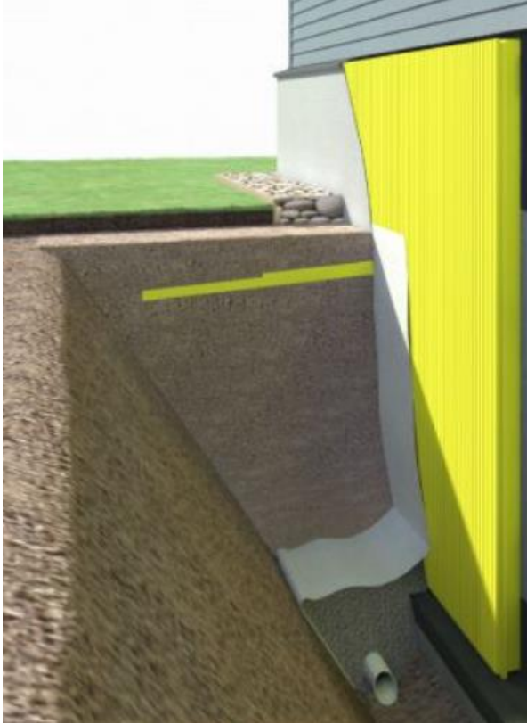
Kuva 8. Levyn ulkopuoliset urat ohjaavat sadevedet salaojiin (Finnfoam 2022)
