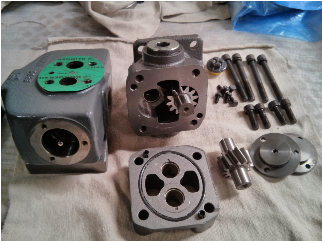
Kuva 3. Pumppu 2 – ulkohammaspyöräpumppu erillisellä suuntaventtiiliköllä.
